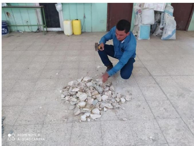
**Figura 4:** trituración de la grava vermiculita.
