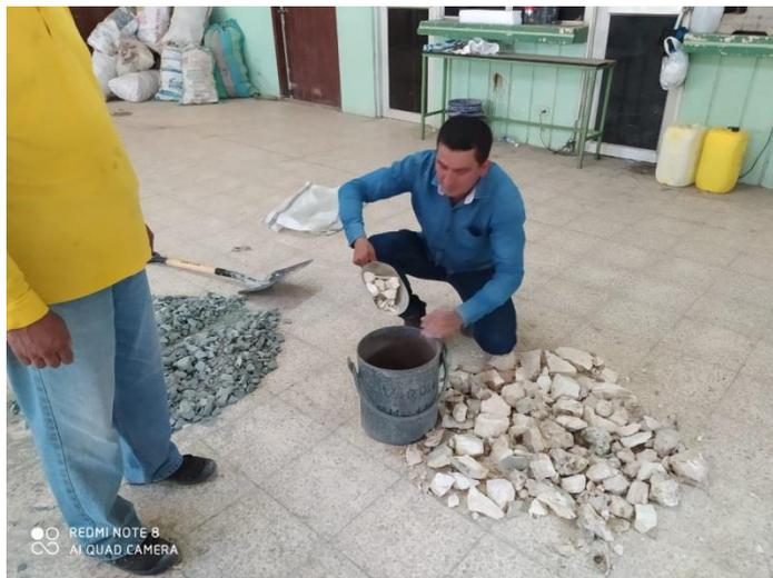
**Figura 6:** peso volumétrico de la vermiculita..
