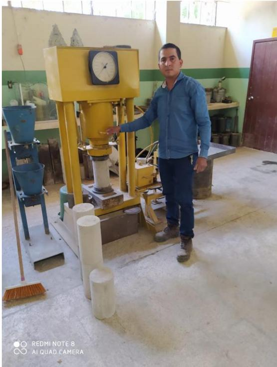
**Figura 7:** rotura del cilindro de hormigón.
