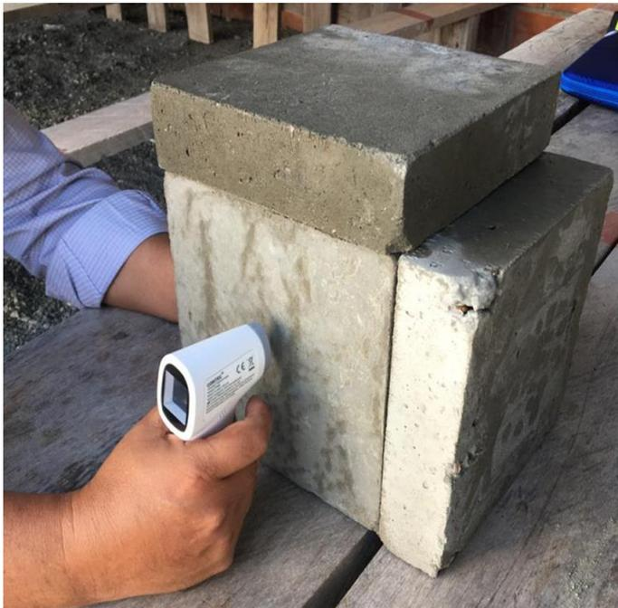
*Figura 9:* toma de temperatura en paneles.
