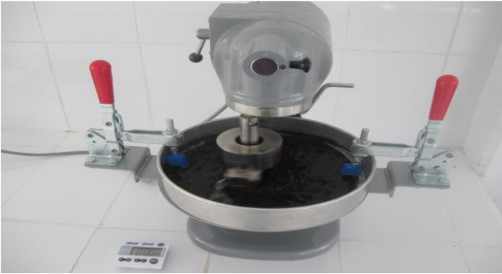
Figura 55 Ensayo de Abrasión en Húmedo – 1 hora WTAT (ISSA TB-100)
