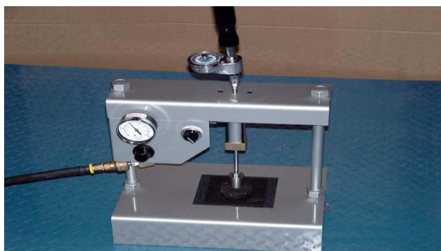
Figura 52 Ensayo de cohesión (ISSA TB -139)
