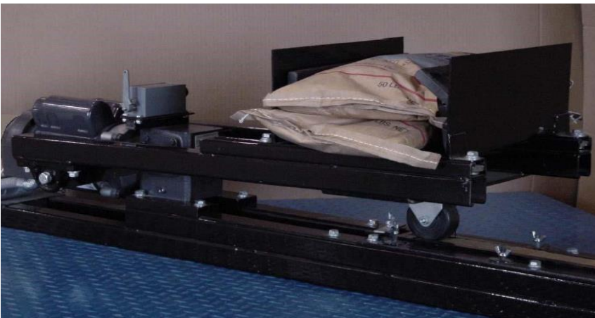
Figura 57 ensayo de rueda cargada y adhesión de arena (ISSA-TB-109)
