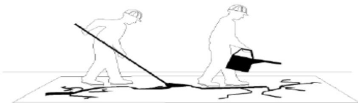
Figura 42 Imagen de google aplicación de riego de liga en la sección que se va a reparar
