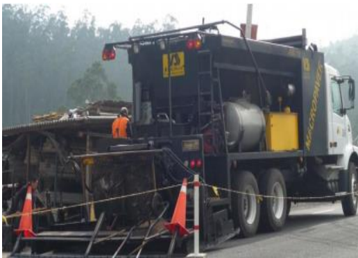
Figura 29 Máquina de mezclado continua Macropaver
