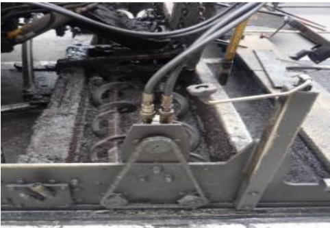
Figura 36 Ingreso de la mezcla a la plancha
