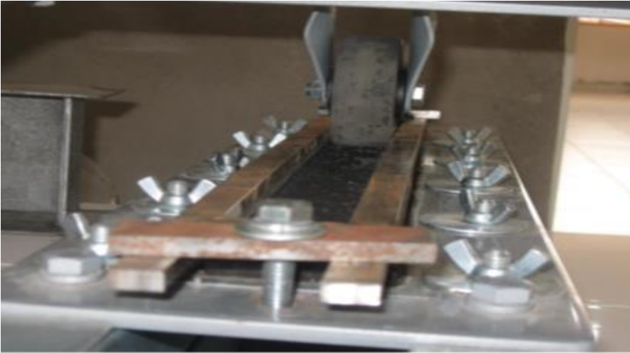
Figura 56 Ensayo de rueda cargada y adhesión de arena (ISSA-TB-109)
