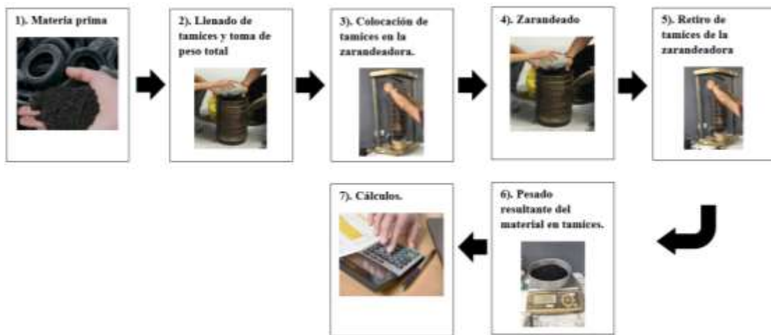
Figura 14 Proceso de tamizado Elaborado por: Martínez & Martillo (2019)
