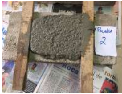
Figura 27 Prueba dosificación 1 cemento:2 arena:2 caucho Elaborado por: Martínez & Martillo (2019)
