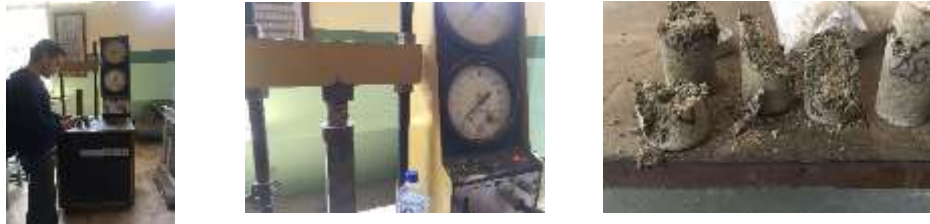
Figura 50: Roturas de cilindros con caucho 1 cemento:2arena:1caucho Elaborado por: Martínez & Martillo (2019)
