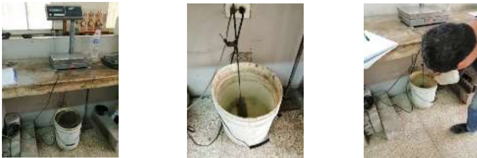
Figura 39: Toma de pesos de cilindros con caucho (1cemento:2arena:2caucho) sumergido en el agua Elaborado por: Martínez & Martillo (2019)
