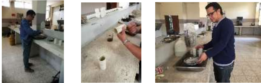
Figura 52: Proceso de preparación de dosificación (1cemento:2arena)
