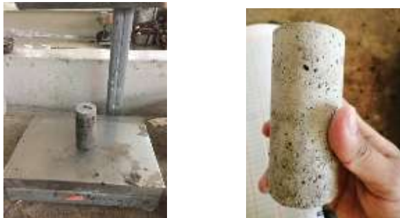
Figura 54: Toma de pesos iniciales de cilindros con mortero tradicional (1cemento:2arena)
