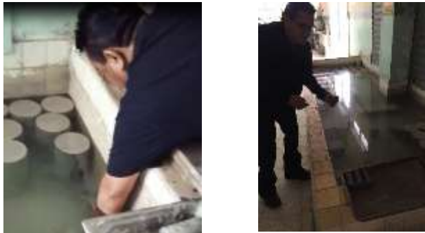
Figura 55: Proceso de curado de cilindros con mortero tradicional (1 cemento:2arena) Elaborado por: Martínez & Martillo (2019)
