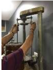
Figura 20 Retiro de tamices de maquina zarandeadora Elaborado por: Martínez & Martillo (2019)
