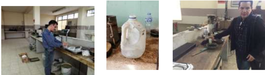
Figura 42 Proceso de preparación de dosificación (1 cemento:2arena:1caucho)
