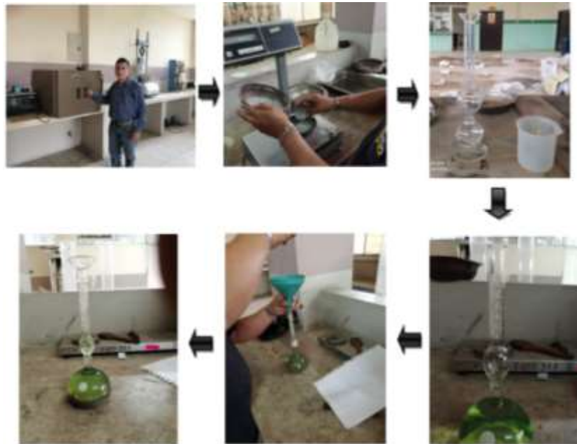
Figura 29: Proceso de prueba densidad del cemento Elaborado por: Martínez & Martillo (2019)
