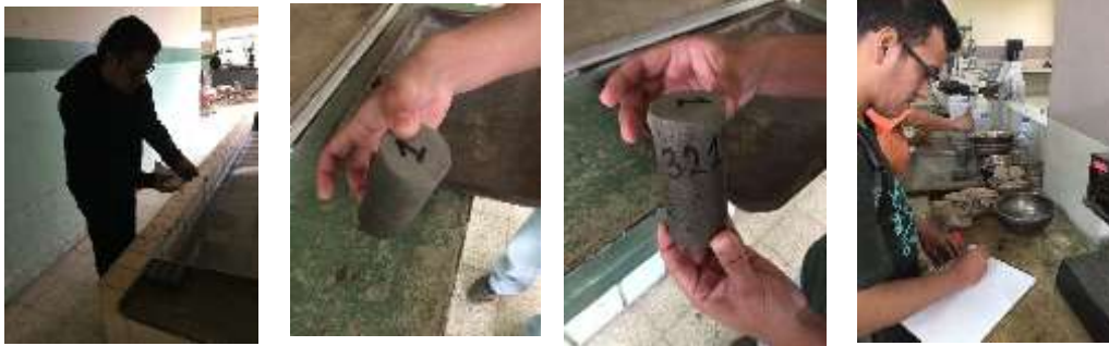
Figura 57: Toma de pesos superficialmente seco de cilindros con mortero tradicional (1 cemento:2arena) Elaborado por: Martínez & Martillo (2019)
