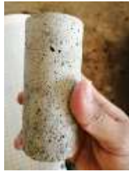
Figura 34: Toma de pesos iniciales de cilindros con caucho (1cemento:2arena:2caucho) Elaborado por: Martínez & Martillo (2019)
