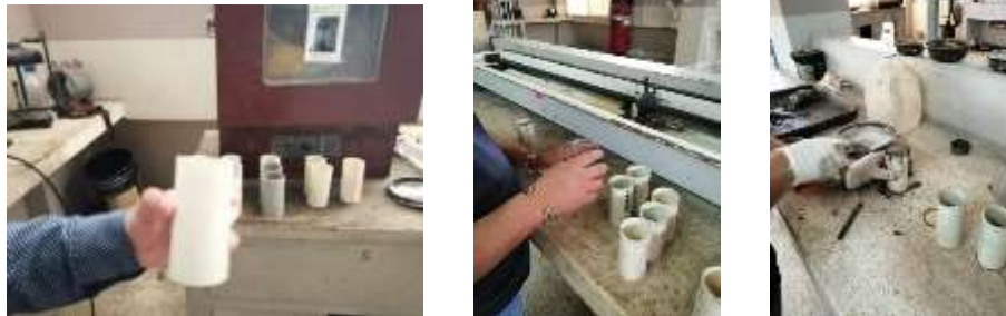
Figura 43: Proceso de elaboración de cilindros con caucho (1cemento:2arena:1caucho) Elaborado por: Martínez & Martillo (2019)
