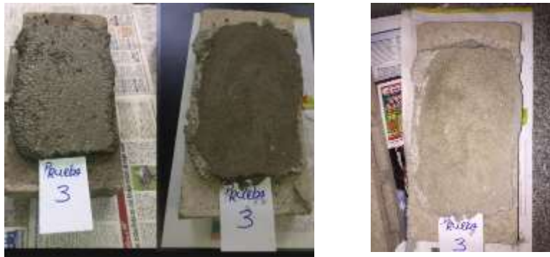
Figura 28: Prueba dosificación 1 cemento:2 arena:1 caucho Elaborado por: Martínez & Martillo (2019)
