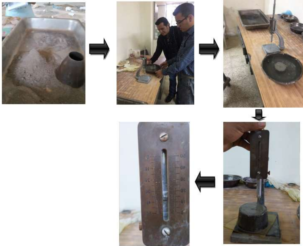
Figura 30: Proceso de consistencia y fraguado del cemento Elaborado por: Martínez & Martillo (2019)
