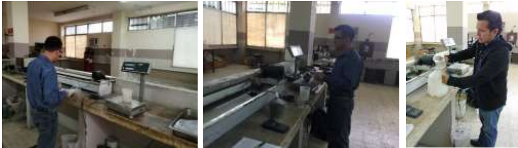
Figura 32: Proceso de preparación de dosificación (1 cemento:2arena:2caucho) Elaborado por: Martínez & Martillo (2019)
