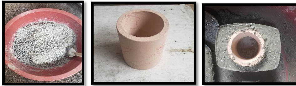
Figura 62: Proceso de mezclado de los materiales para la elaboración del hormigón simple de la muestra #4 Elaborado por: Choez & Torres (2019)
