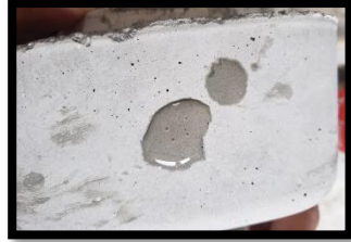
Figura 72: Resultados obtenidos con el sellador repelente al agua Elaborado por: Choez & Torres (2019)
