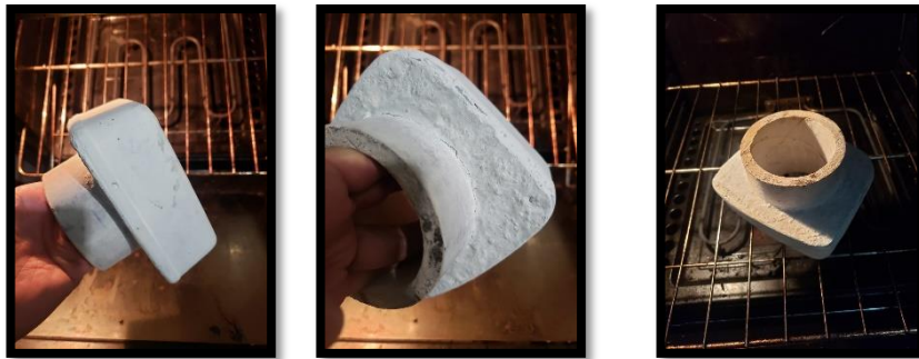
Figura 85: Verificación de prueba de calor a 200 grados centígrados Elaborado por: Choez & Torres (2019)
