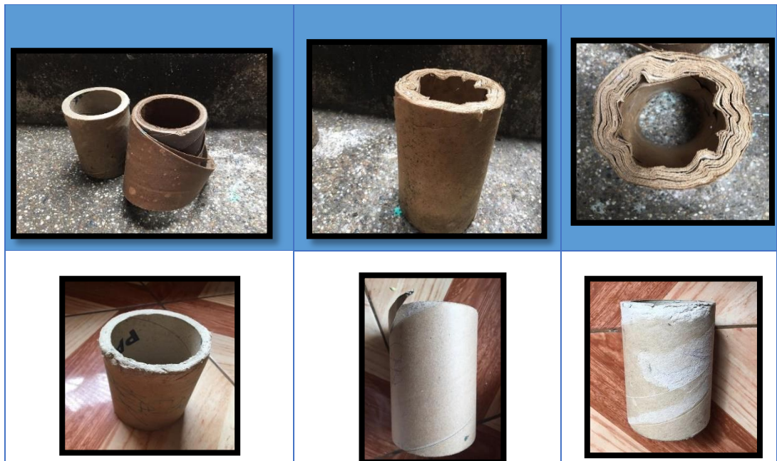
Figura 45: Estado de deterioro de algunos tubos de cartón recolectados en la empresa Estrusa
