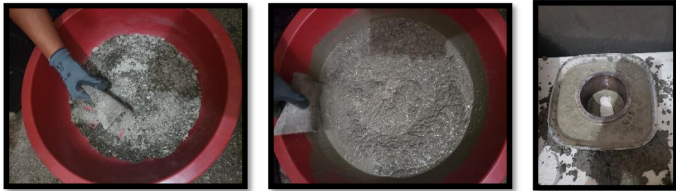
Figura 56: Proceso de mezclado de los materiales para la elaboración del hormigón simple de la muestra #1
