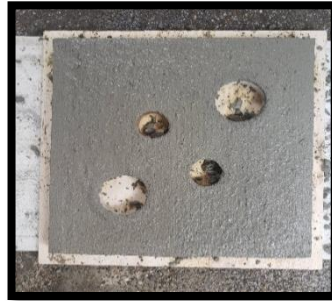
Figura 67: Vibrado manual del panel decorativo Elaborado por: Choez & Torres (2019)
