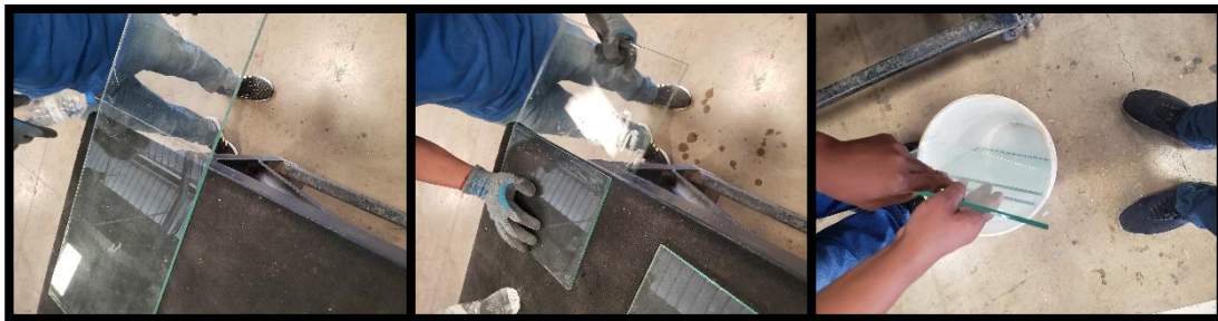
Figura 39: Selección y corte del vidrio en piezas pequeñas Elaborado por: Choez & Torres (2019)
