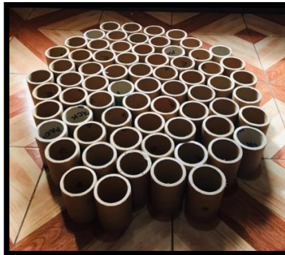
Figura 46: Selección de los tubos de cartón con características óptimas para el proceso experimental del panel decorativo
