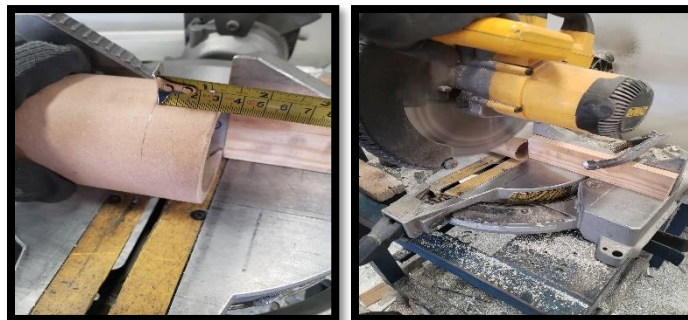
Figura 47: Proceso de medición de los tubos de cartón seleccionados Elaborado por: Choez & Torres (2019)
