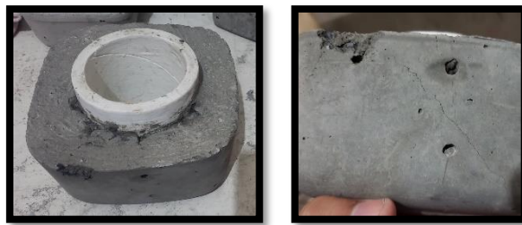
Figura 61: Resultados obtenidos de la muestra de hormigón con tubos de cartón tratados con impermeabilizante Elaborado por: Choez & Torres (2019)
