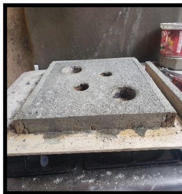
Figura 68: Curado y desencofrado del panel decorativo Elaborado por: Choez & Torres (2019)
