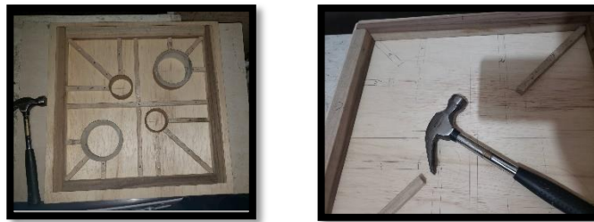
Figura 34: Proceso de colocación de las tiras de madera que conforman el relieve interior del molde decorativo Elaborado por: Choez & Torres (2019)
