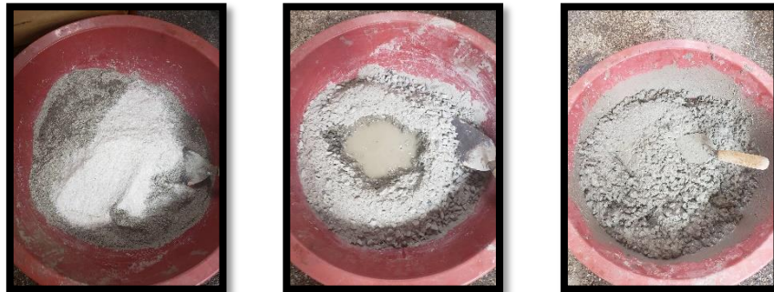
Figura 65: Proceso de incorporación de los materiales a la mezcla de hormigón del prototipo #5 Elaborado por: Choez & Torres (2019)
