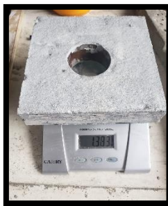
Figura 81: Quinta etapa de la prueba de humedad Elaborado por: Choez & Torres (2019)
