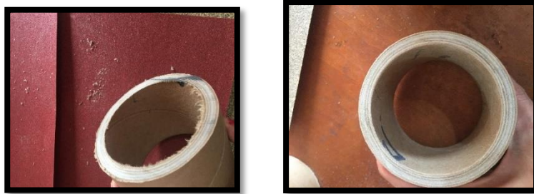
Figura 49: Proceso de eliminación de impurezas de los tubos de cartón. Elaborado por: Choez & Torres (2019)
