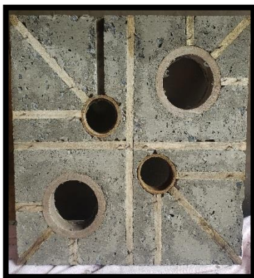
Figura 68: Curado y desencofrado del panel decorativo Elaborado por: Choez & Torres (2019)
