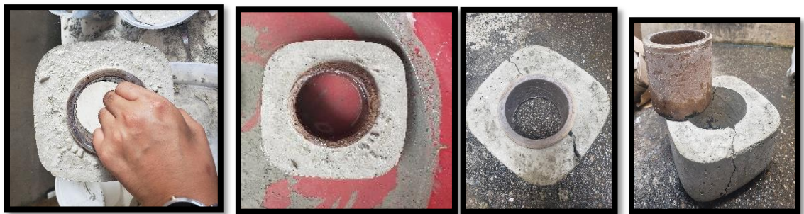
Figura 57: Resultados del prototipo de hormigón con tubo de cartón tratado con resina
