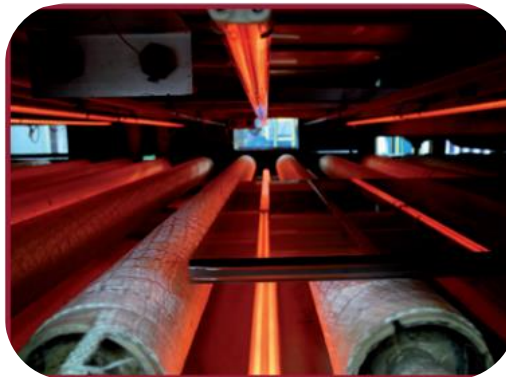
Figura 17: Calandrado del vidrio laminado Fotografía: Glass Solution
