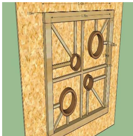
Figura 29: Prototipo de molde decorativo de madera a construir Elaborado por: Choez & Torres (2019)
