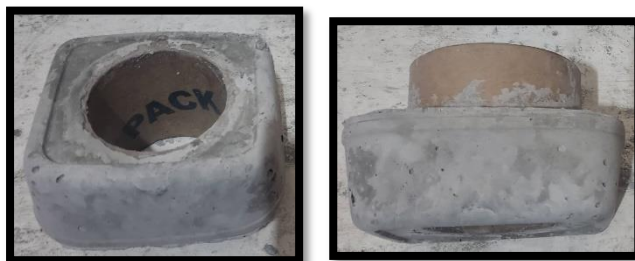
Figura 59: Resultados obtenidos de la muestra de hormigón con el tubo de cartón con tratamiento de blancola Elaborado por: Choez & Torres (2019)
