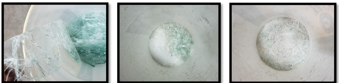
Figura 41: Proceso de triturado del vidrio Elaborado por: Choez & Torres (2019)
