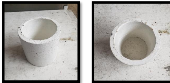
Figura 53: Sika Transparente impermeabilizante para los tubos de cartón Tomado por: Choez & Torres (2019)
