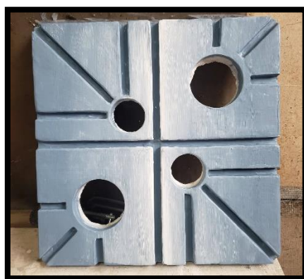
Figura 76: Resultado obtenido de la coloración de la muestra con pintura látex Elaborado por: Choez & Torres (2019)
