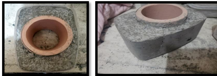
Figura 63: Resultados obtenidos de la muestra del tubo con tratamiento de pintura Elastomérica Elaborado por: Choez & Torres (2019)
