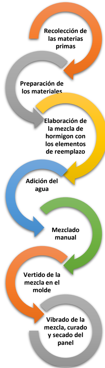
Figura 28: Flujo del proceso constructivo del panel decorativo Elaborado por: Choez & Torres (2019)
