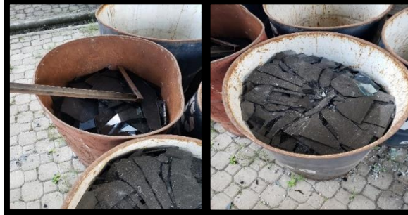
Figura 38: Cubos de recolección del vidrio mezclado entre tipo laminado y crudo de la empresa Estrusa Elaborado por: Choez & Torres (2019)
