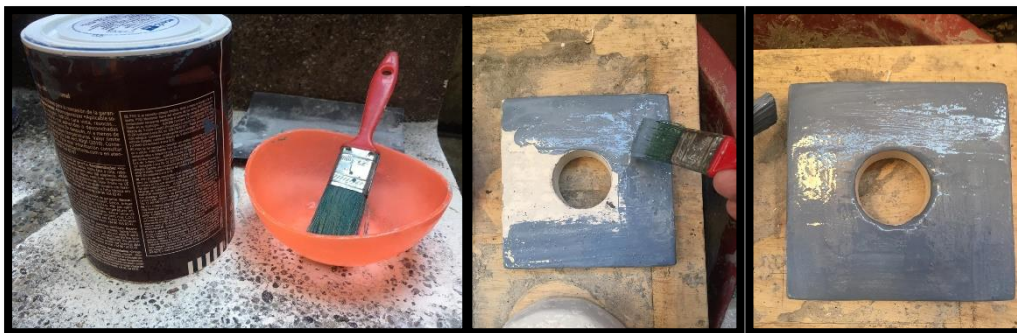
Figura 75: Coloración de la muestra con pintura látex Elaborado por: Choez & Torres (2019)
