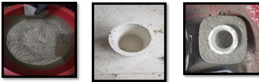
Figura 60: Proceso de mezclado de los materiales para la elaboración del hormigón simple de la muestra #3 Elaborado por: Choez & Torres (2019)
