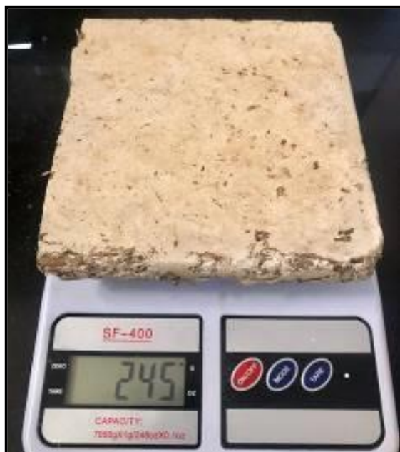
Ilustración 55: Probeta después de una hora en horno a temperatura 180°C Elaborado por: Bayas, P. 2020.
