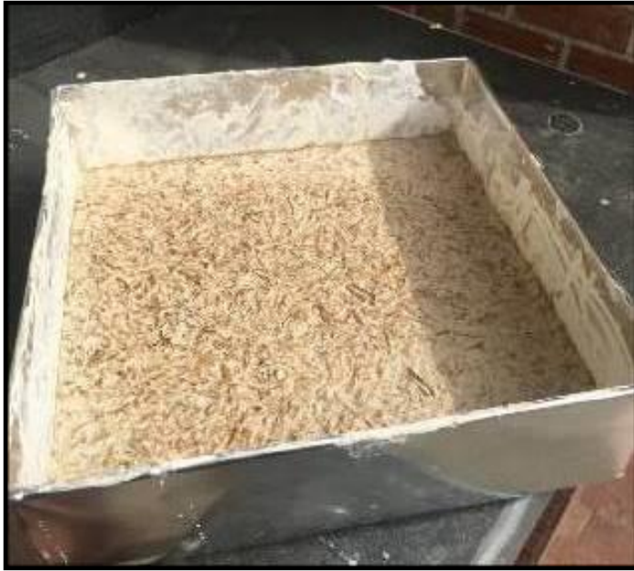
Ilustración 45: Mezcla de prototipo después de 24 horas Elaborado por: Bayas, P. 2020.
