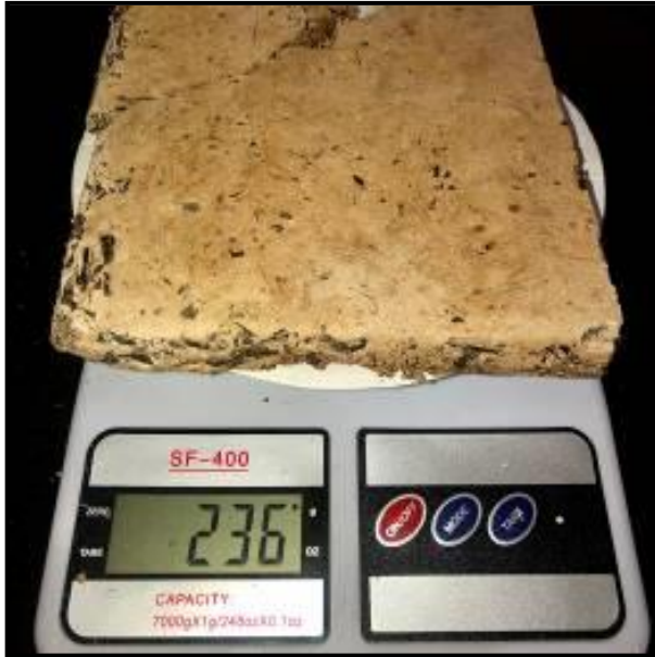
Ilustración 56: Probeta después de una hora en horno a temperatura de 240°C Elaborado por: Bayas, P. 2020.
