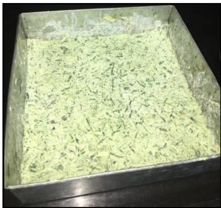
Ilustración 32: Proceso de secado de mezcla 1 en molde de 0.30x0.30cm Elaborado por: Bayas, P. 2020.
