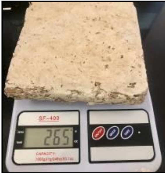
Ilustración 54: Probeta después de una hora en horno a temperatura 120°C Elaborado por: Bayas, P. 2020.
