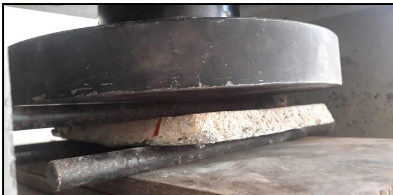
Ilustración 57: Probeta durante el ensayo de flexión Elaborado por: Bayas, P. 2020.
