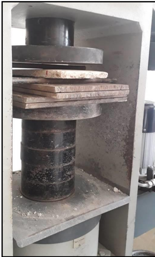
Ilustración 58: Probetas Durante el ensayo de Flexión Elaborado por: Bayas, P. 2020.
