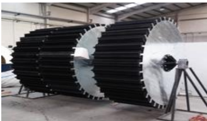
Figura 4: Moderna configuración de Biodiscos. Fuente: Bioplast Depuración (s.f.)
