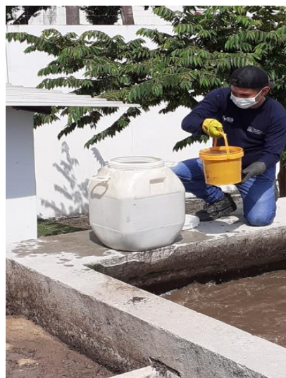
Figura 27: Extracción de agua residual de Laguna de aireación Elaborado por: Blanco & Guzmán. (2020)
