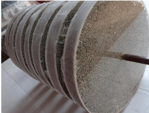
Figura 19: Llenado de Zeolita dentro de los discos. Elaborado por: Blanco & Guzmán. (2020)
