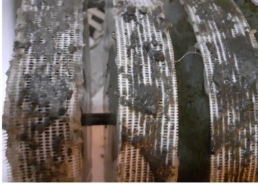
Figura 39: Película líquida generado en etapa de reacción. Elaborado por: Blanco & Guzmán. (2020)
