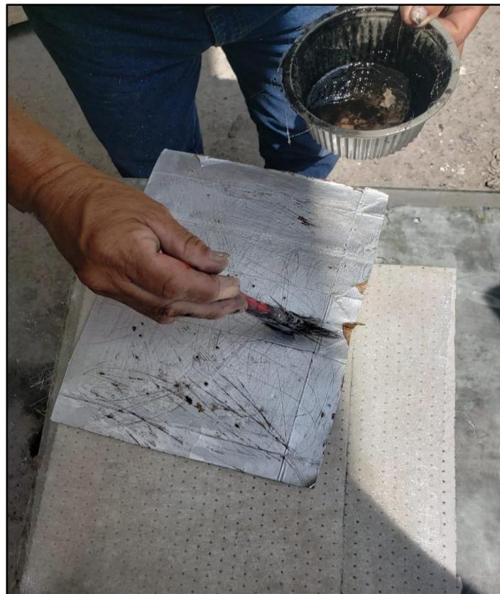
**Figura 42.** Ubicación de la resina al tetrabrik lijado segunda prueba
