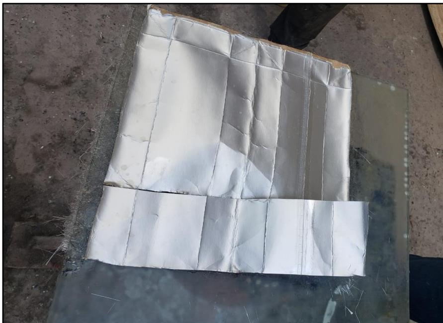
*Figura 35. Tetrabriks colocados sobre la fibra de vidrio con resina
