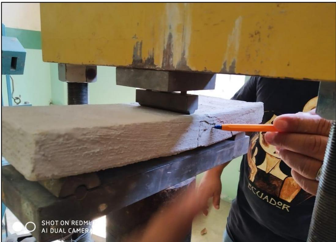
*Figura 58. Panel en prueba de flexión*
