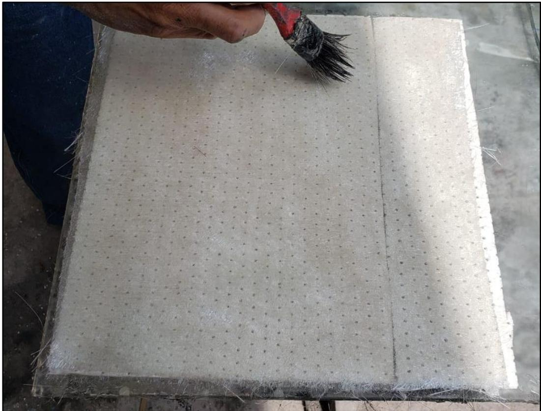
*Figura 40. Proceso de pegado del coremat con la resina y fibra de vidrio segunda prueba
