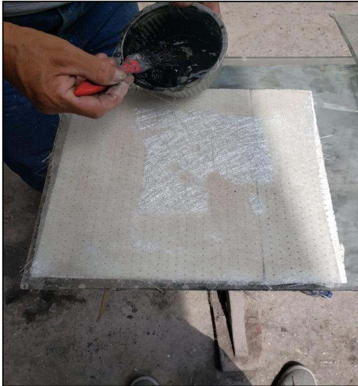
**Figura 41.** Ubicación de la resina al coremat segunda prueba
