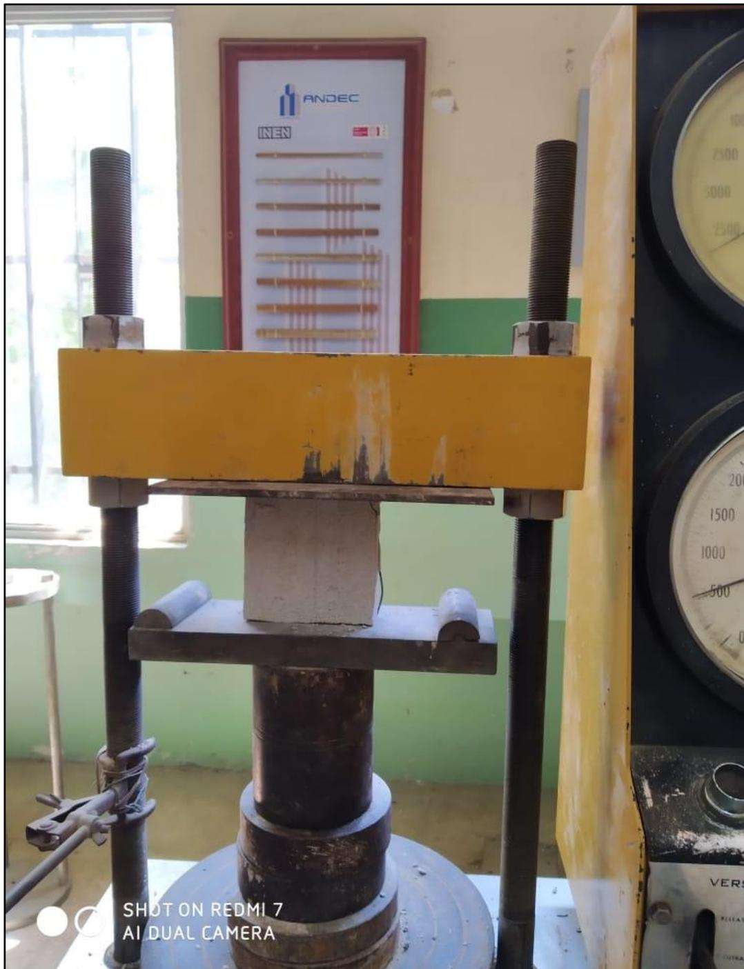
**Figura 53.** Panel en prueba de compresión
