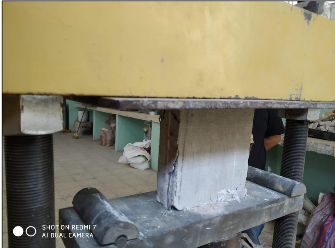
*Figura 54. Panel en prueba de compresión
