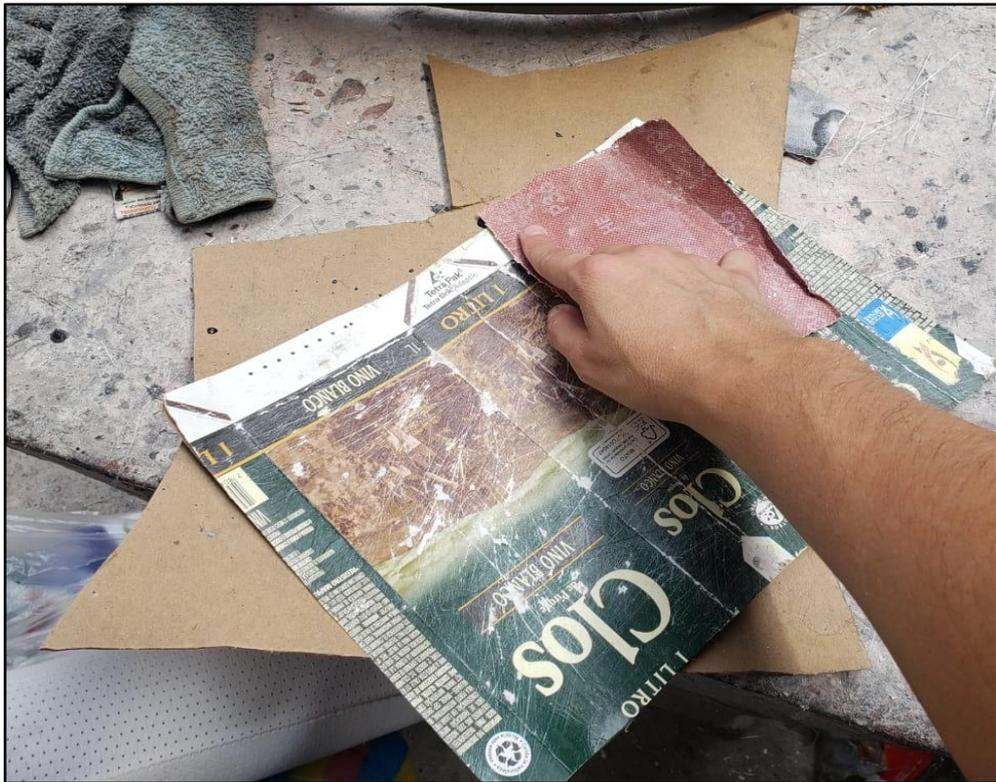
*Figura 38. Proceso de lijado a los paquetes de tetrabrik
