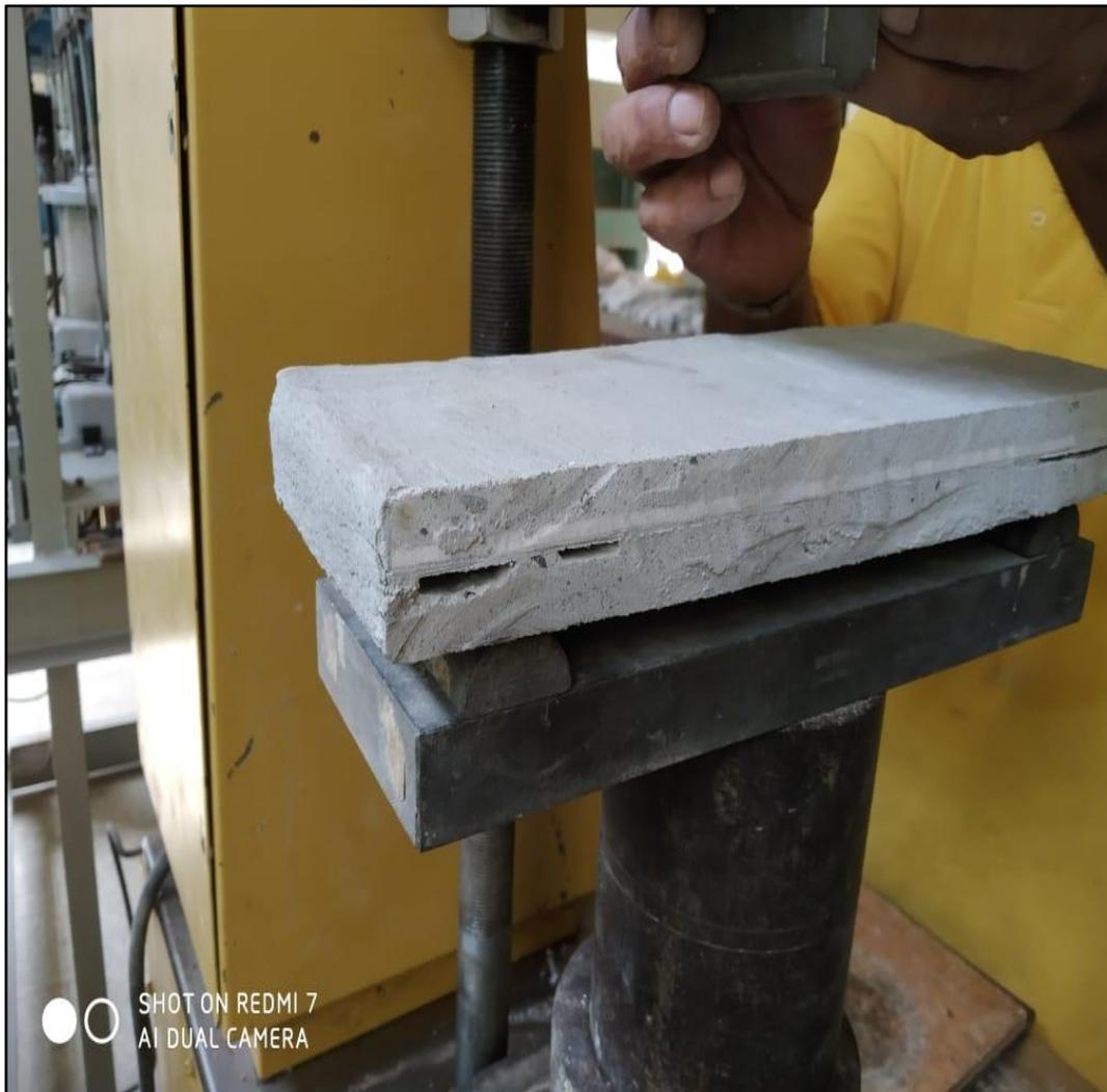
**Figura 56.** Panel en prueba de flexión
