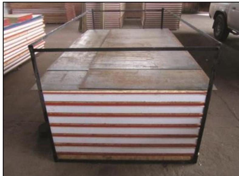
**Figura 12.** Prensado paneles SIP.
