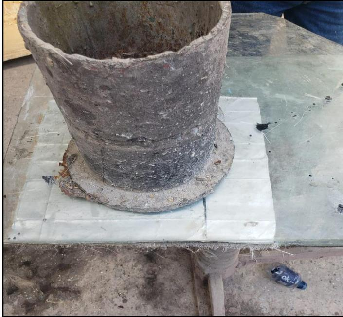
**Figura 36.** Presión empírica para pegado de tetrabrik con fibra de vidrio
