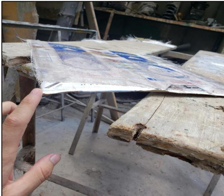
**Figura 37.** Acabado final de la fibra de vidrio con el tetrabrik
