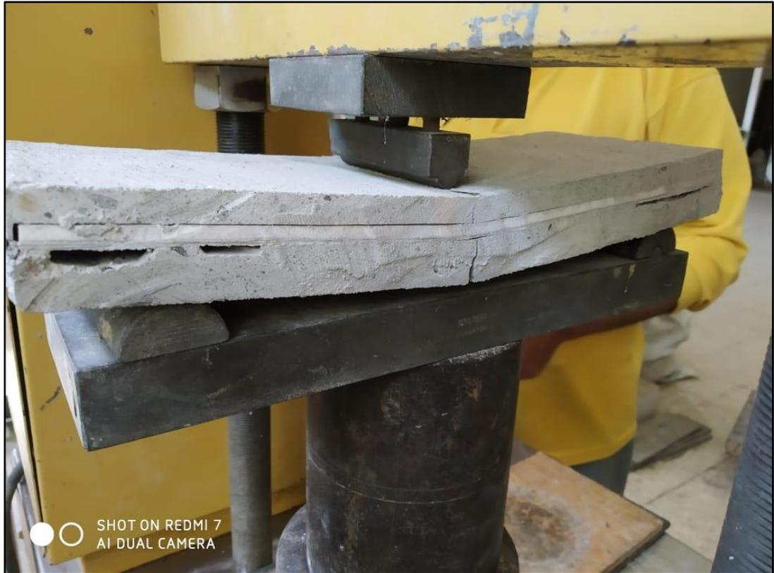
*Figura 57. Panel en prueba de flexión*
