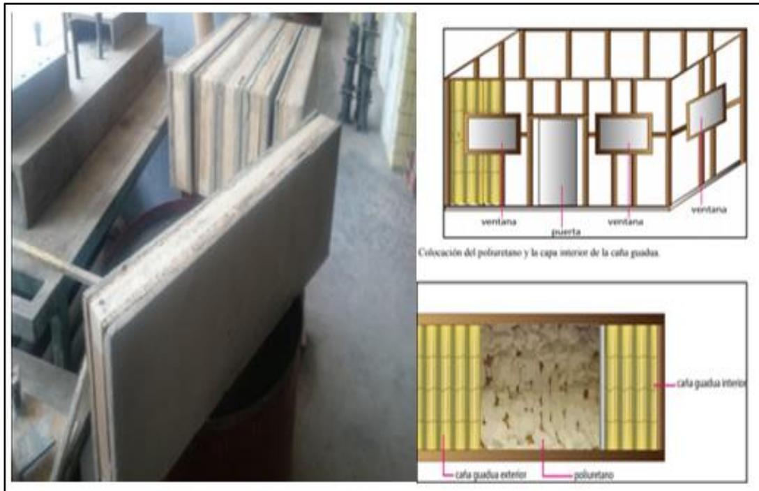
**Figura 7.** Paneles prefabricados de caña guadua y poliuretano.
