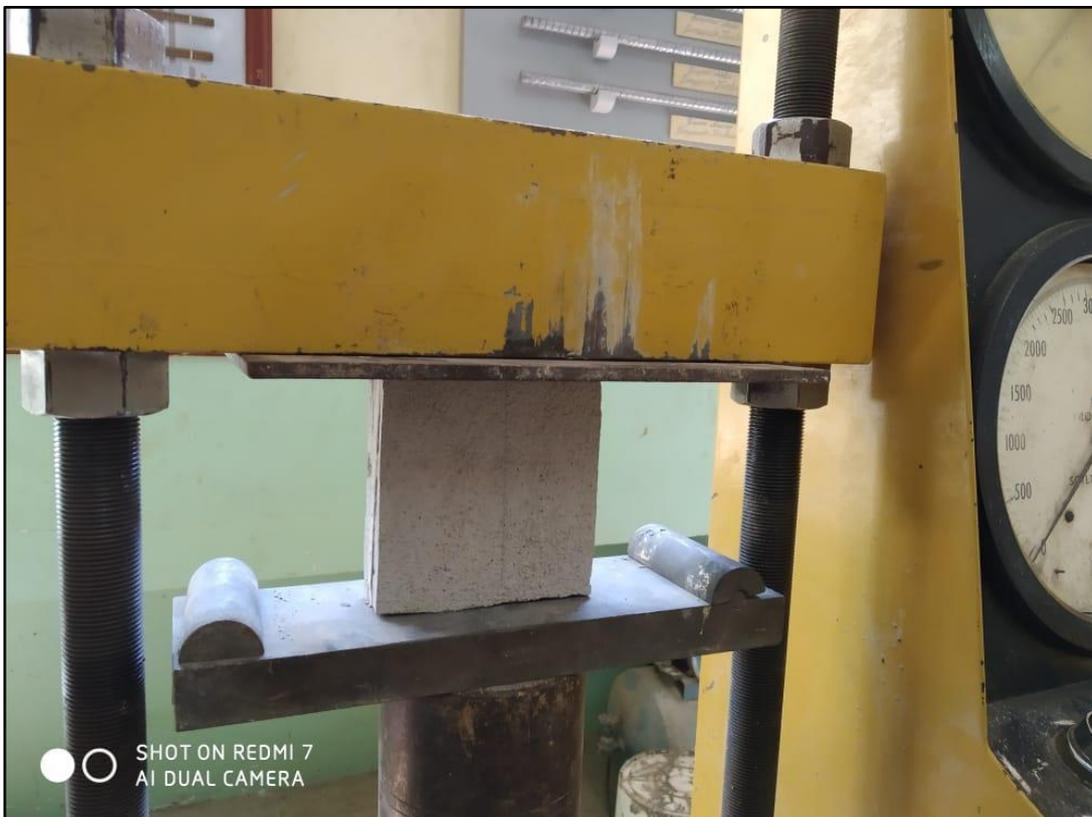
*Figura 55. Panel en prueba de compresión
