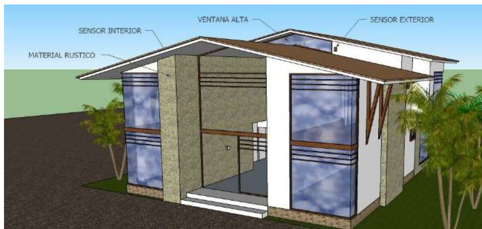
Ilustración 11 Ubicación de sensores Higrotérmico.
