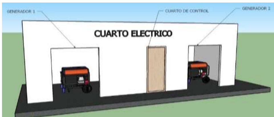
Ilustración 9 Distribución del cuarto eléctrico para generadores.
