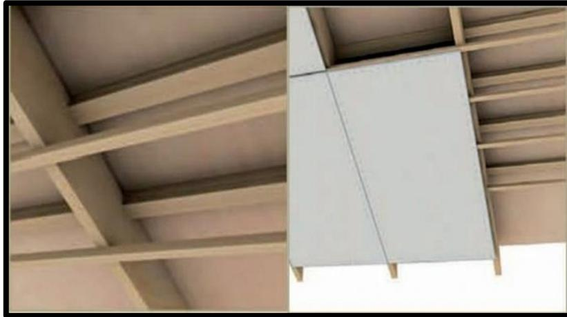
**Figura 45.** Cielo raso Drywall.
