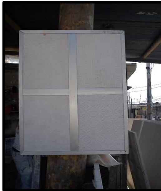
*Figura 91.* Prototipo de yeso texturizado en 4 modelos de presentación.
