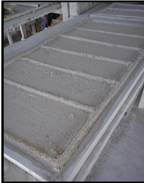
*Figura 90.* Falla por exceso de cáscara de arroz.
