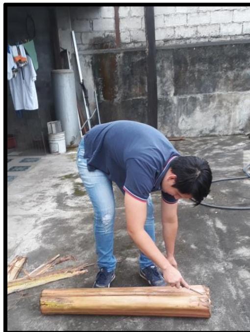
*Figura 53.* Extracción de capa del seudotallo.
