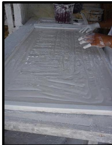
*Figura 76.* Recubrimiento de la mezcla en el molde.
