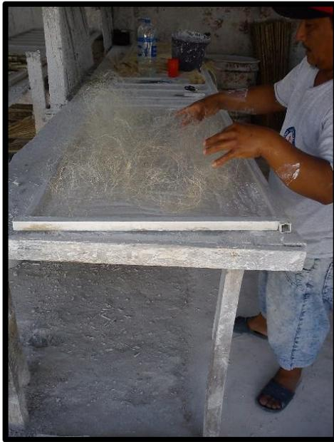
**Figura 77.** Colocación de la fibra de banano.
