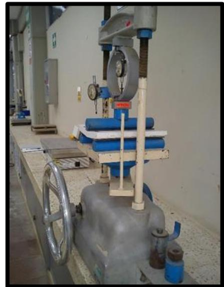
**Figura 70.** Prensa para ensayos a flexión.
