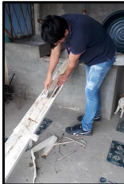
*Figura 55.* Retiro de la pulpa para extracción de la fibra.
