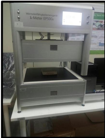
**Figura 69.** Medidor de conductividad térmica de placa caliente.
