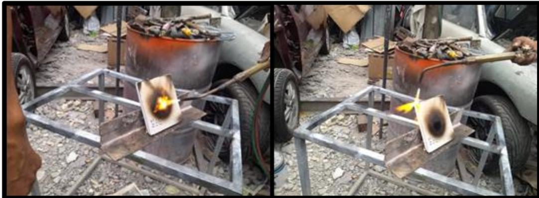
*Figura 94.* Ensayo de reacción al fuego por el método empírico.
