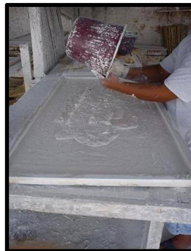
**Figura 80.** Mezcla compuesta de yeso y cáscara de arroz.
