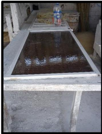
*Figura 67.* Molde de vidrio con encofrado de aluminio.
