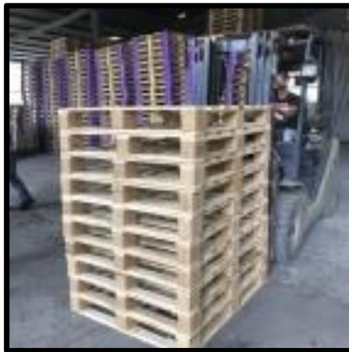
*Figura 6.* Tarima fabricada con una mezcla de fibra de plátano y resina.
