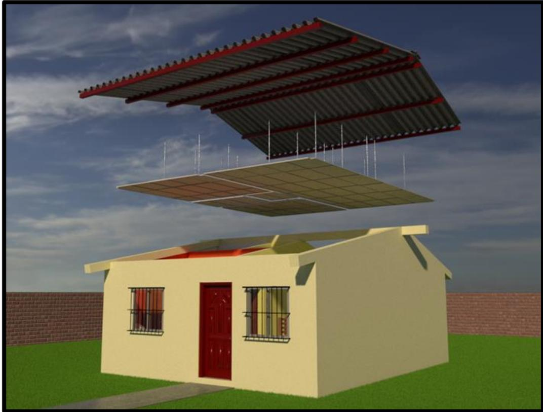
**Figura 108.** Modelado 3D vivienda MIDUVI detalle estructural.
