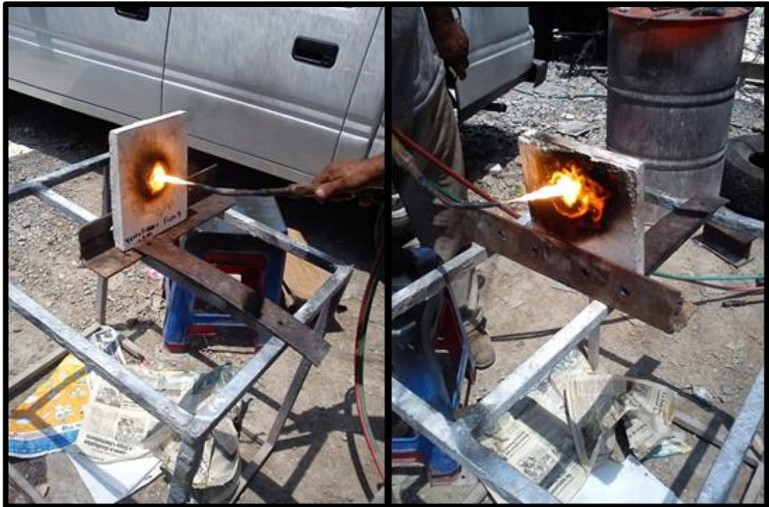
*Figura 93.* Ensayo de reacción al fuego por el método empírico.
