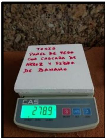
**Figura 97.** Peso prototipo de panel propuesto.
