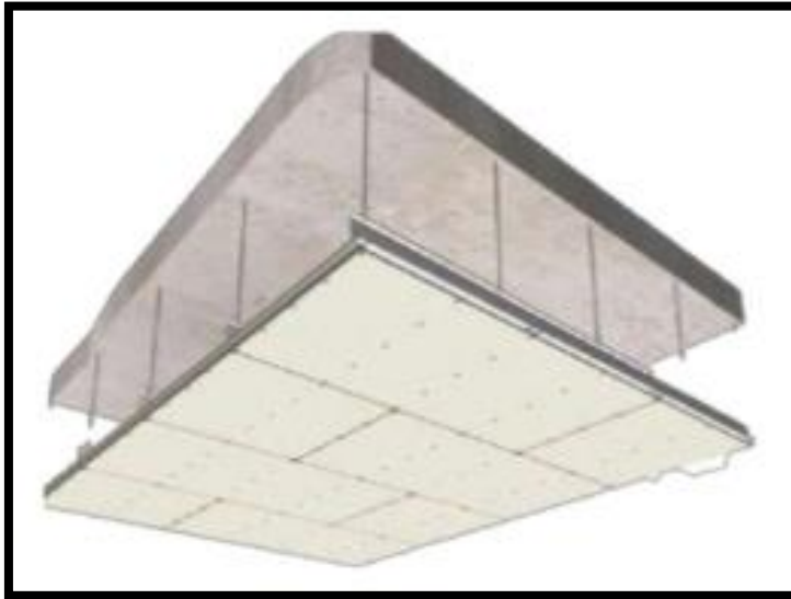
Figura 19: Estructura en Drywall suspendida Fuente: Mestas, 2018.
