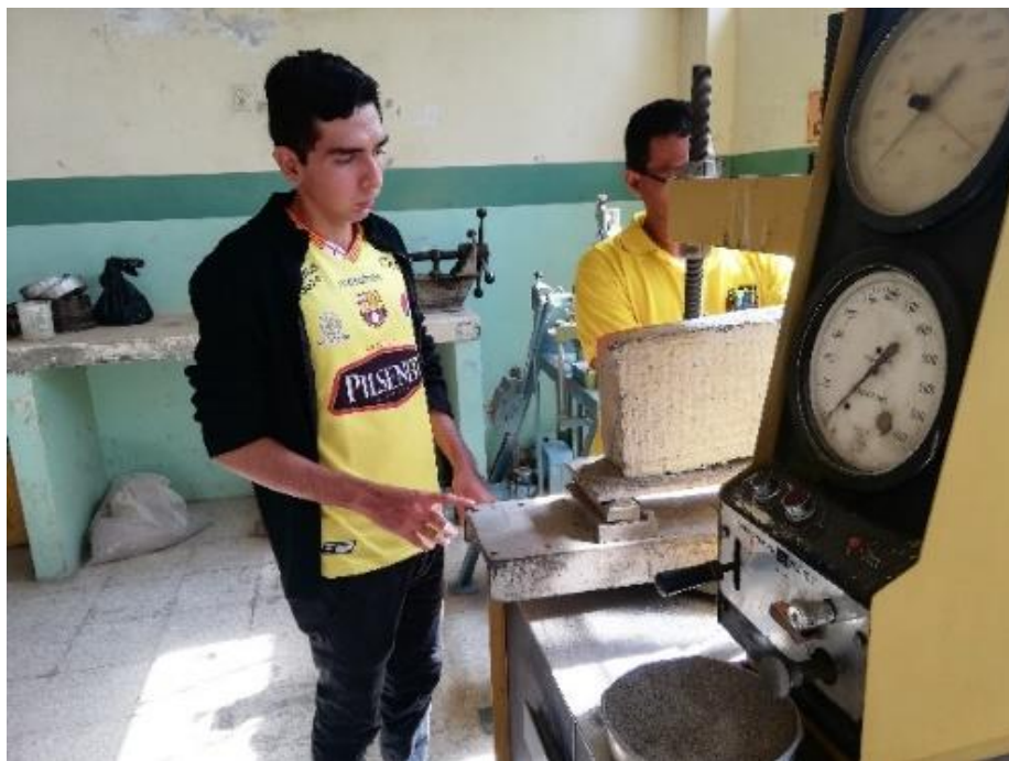
Figura 30 bloque listo para el ensayo de compresión
