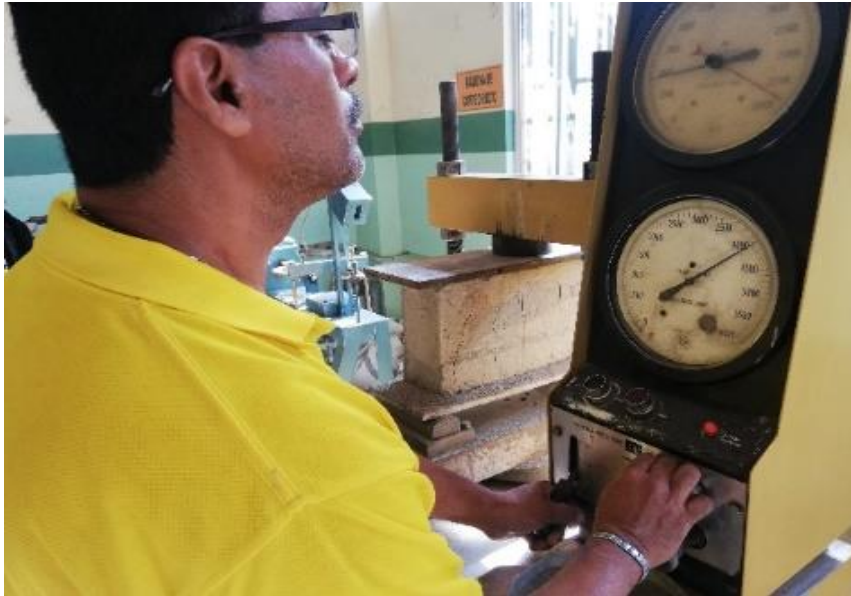
Figura 33 El ensayo da como carga máxima 4200 Kg
