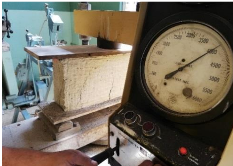
Figura 32 El ensayo da como carga máxima 4000Kg
