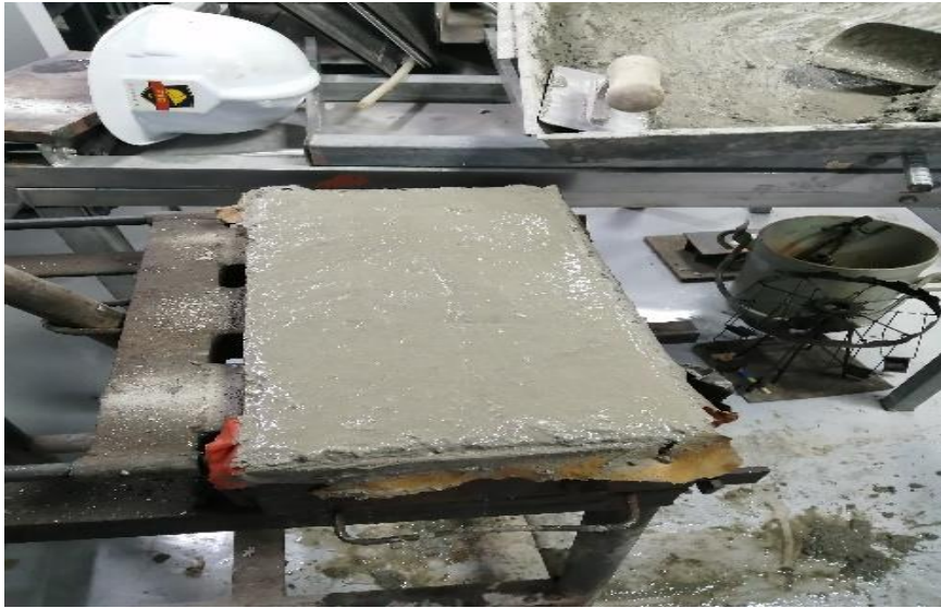
Figura 26. Mezcla dentro de molde metálico
