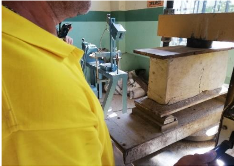
Figura 31 Bloque recibiendo carga
