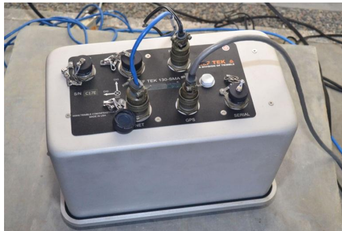
Figura 25. Acelerógrafo medidor de intensidades sísmicas. Fuente: Los Campaña & Goya (2019)
