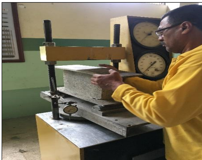
Figura 77: Plancha de metal para comprimir de manera uniforme sobre el bloque Elaborado por: Castro & Farfán (2019)
