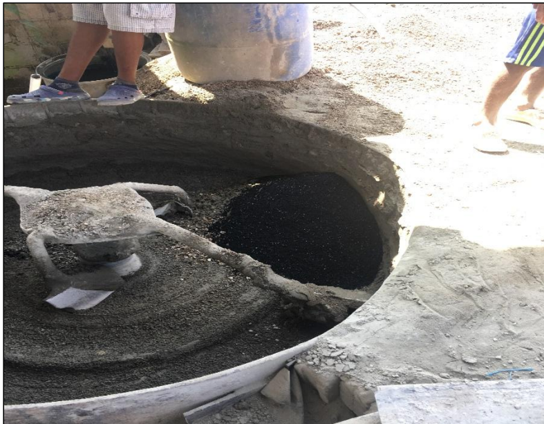
Figura 60: Caucho triturado agregado al eco-bloque Elaborado por: Castro & Farfán (2019)
