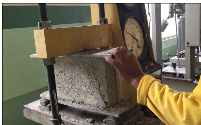
Figura 76: Bloque ubicado en la máquina de presión Elaborado por: Castro & Farfán (2019)
