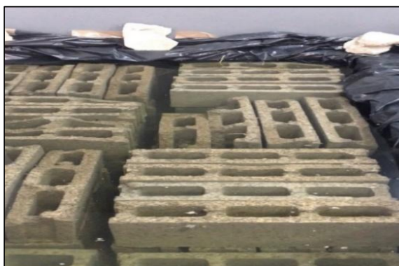
Figura 72: Bloques sumergidos durante 24 horas Elaborado por: Castro & Farfán (2019)
