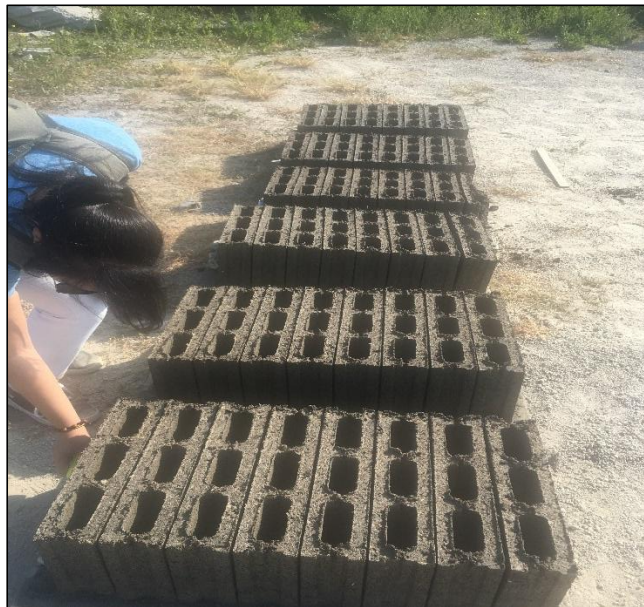
Figura 64: Desmolde de los eco-bloques Elaborado por: Castro & Farfán (2019)
