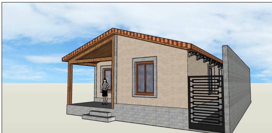
Figura 78: Diseño de la vivienda de interés social elaborada con eco-bloques a base de caucho triturado y aserrín.
