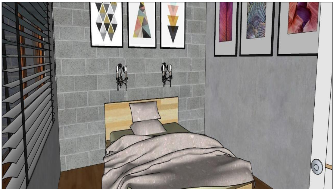
Figura 86: Habitación con el fondo de pared donde se aprecia los eco-bloques a base de caucho triturado y aserrín. Elaborado por: Castro & Farfán (2019)
