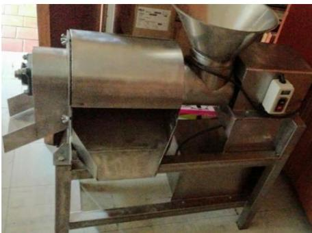
*Figura 13. Máquina despulpadora Ecoserv*
