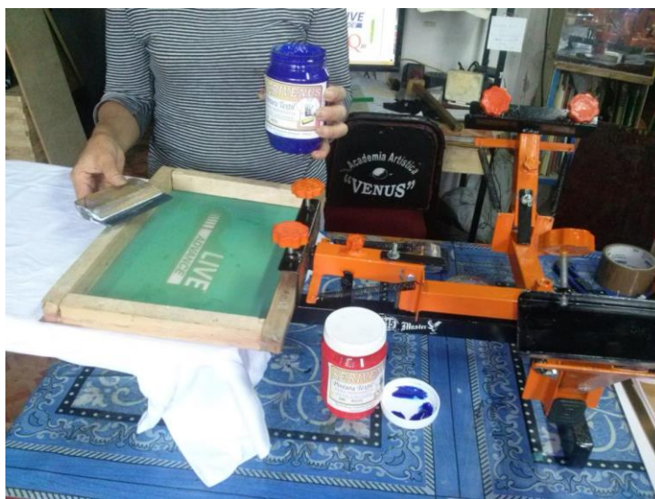
Ilustración 14: Colocación de los bastidores en el Pulpo
