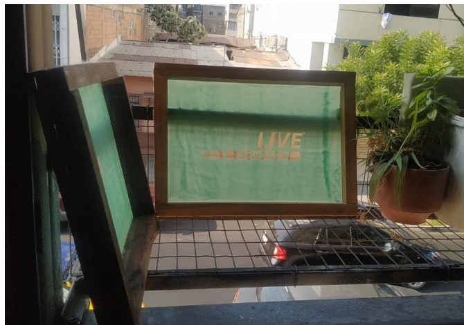
Ilustración 12: Fijación de revelado y Secado del bastidor
