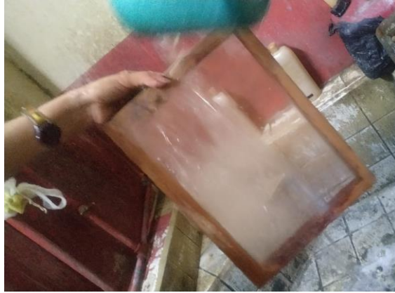
Ilustración 3: Desengrasada del bastidor
