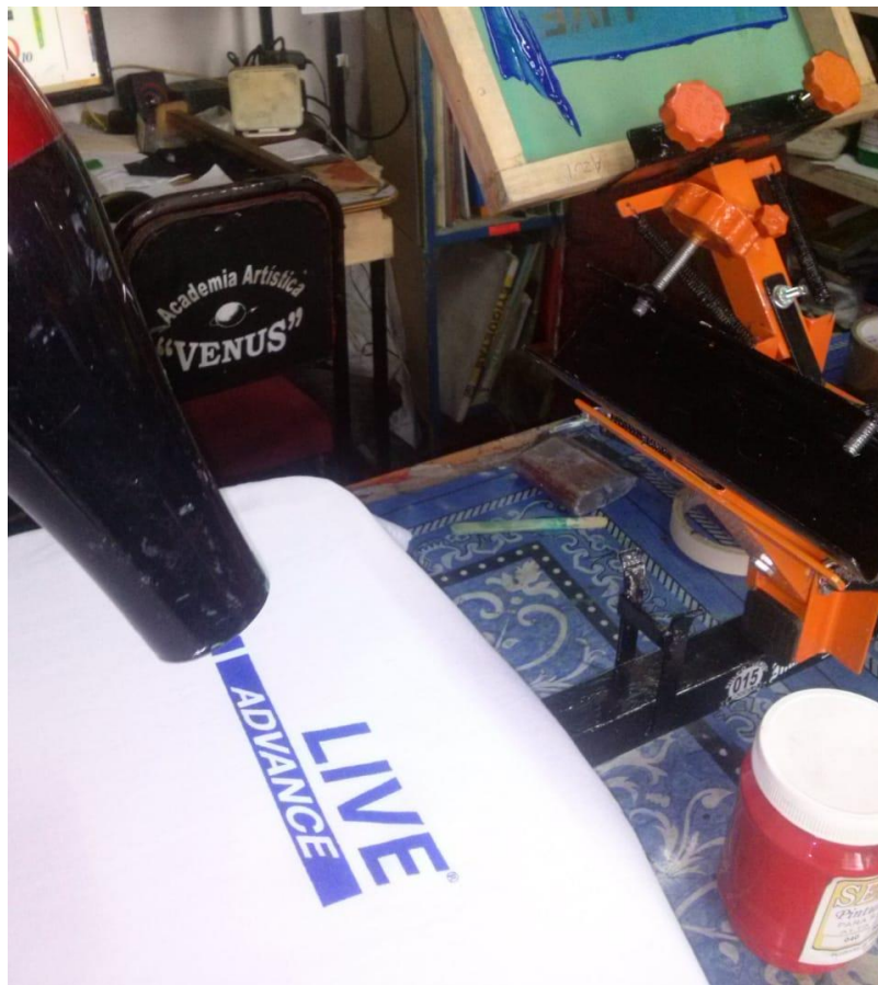
Ilustración 16: Secado de la impresión del primer color
