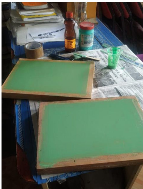
Ilustración 8: Colocación de la Foto emulsión en el bastidor
