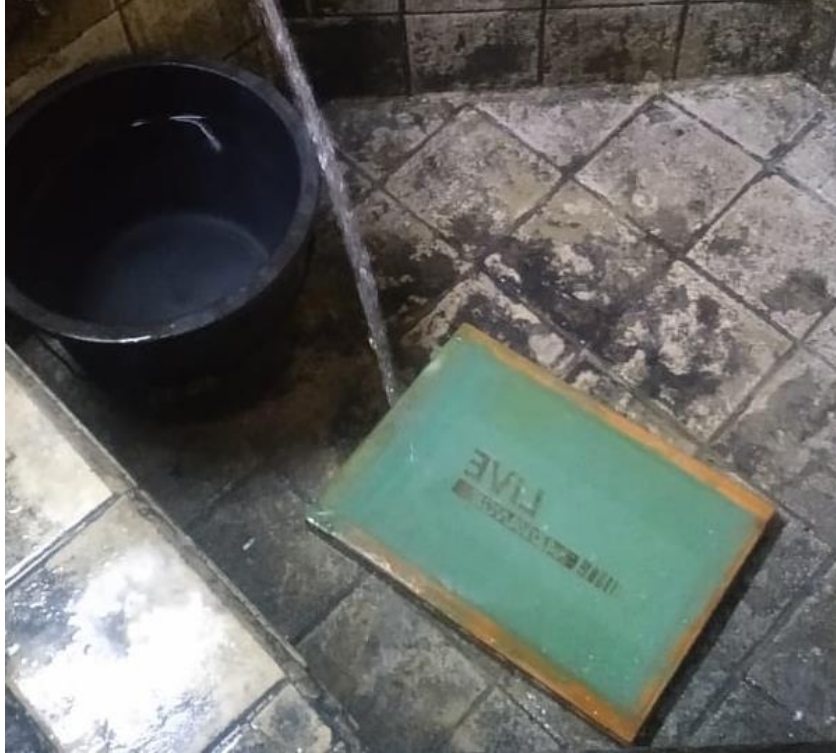
Ilustración 11: Lavado del bastidor
