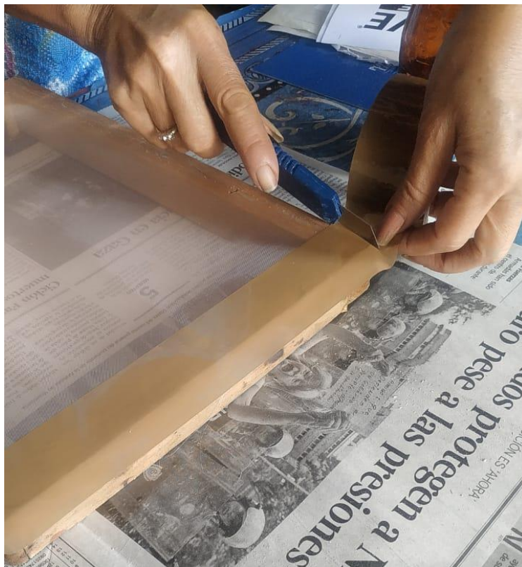
Ilustración 4: Reforzamiento del bastidor
