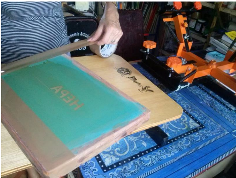
Ilustración 13: Preparación del bastidor para el proceso de estampado
