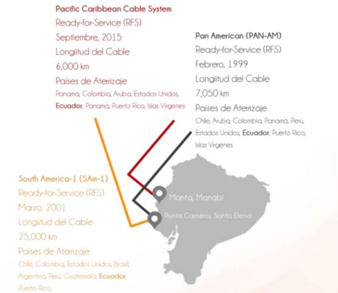
**Imagen 3:** cables submarinos que conectan a Ecuador.
