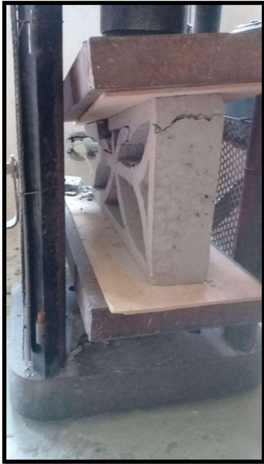
Imagen 73. Prueba a la compresión Elaborado por: Laje & Lliguin (2019)
