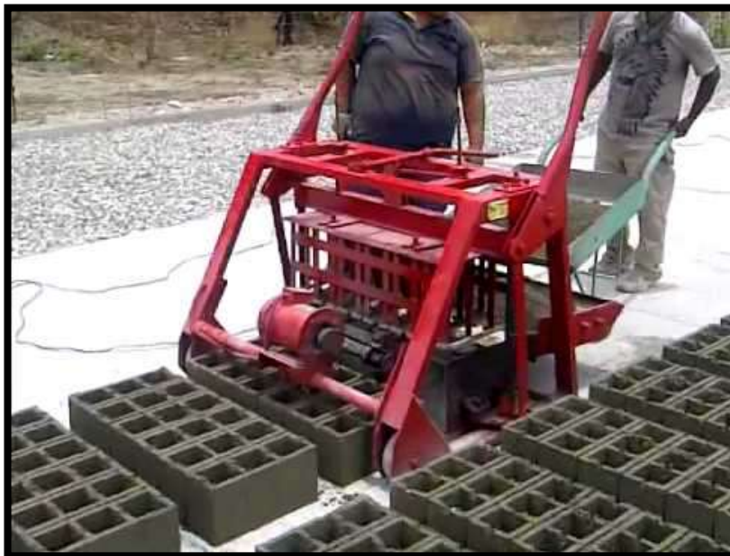
Imagen 26. Obtención de bloques mediante máquinas Fuente: Youtube (2015)
