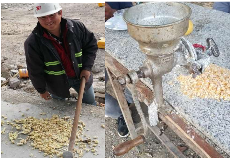
Imagen 57 proceso de trituración de tuzas de maíz
