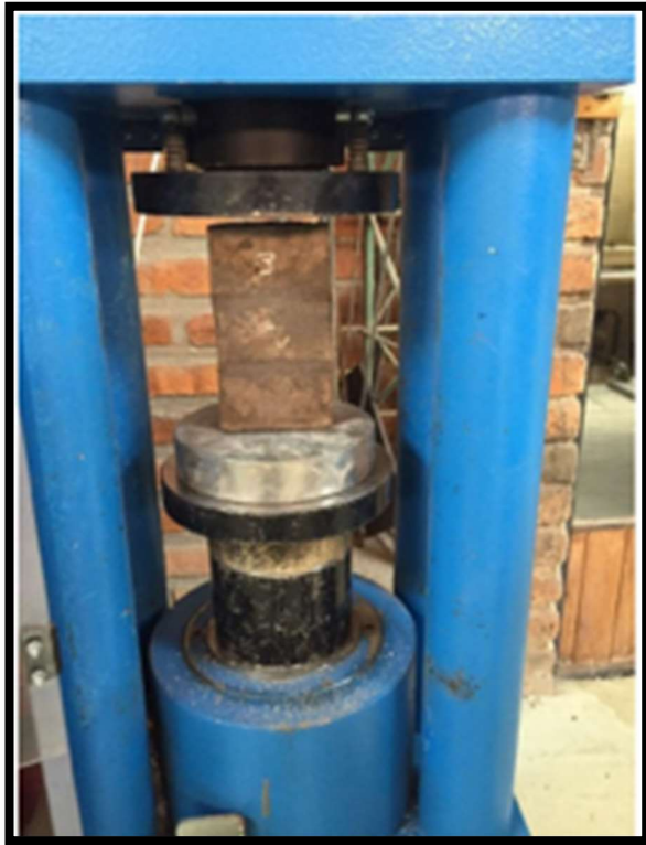
Imagen 6. Prueba a la compresión de bloques con sílice Fuente: Calle, (2015)
