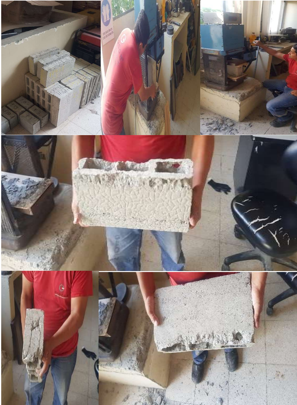
Imagen 75 ensayos de compresión al bloque decorativo
