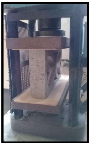
Imagen 71. Prueba a la compresión muestra 7 Elaborado por: Laje & Lliguin (2019)
