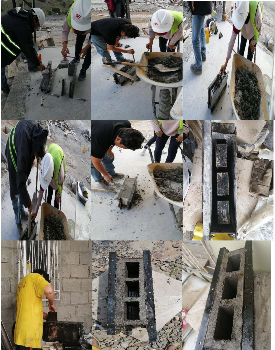
Imagen 61 Relleno del molde del bloque decorativo
