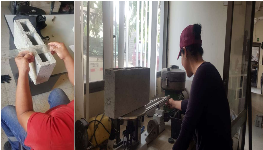
Imagen 74 medición y pesado del bloque decorativo
