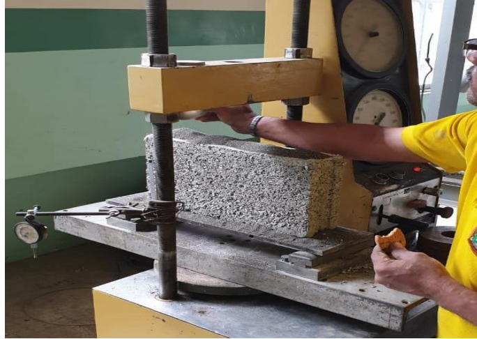
Figura 50 Bloque ubicado en la máquina de presión Tomada por: Macancela. A & Martínez. A (2019)
