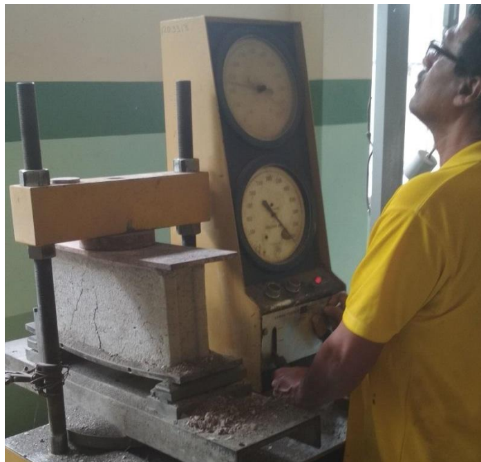
Figura 51 Compresión del bloque Tomada por: Macancela. A & Martínez. A (2019)
