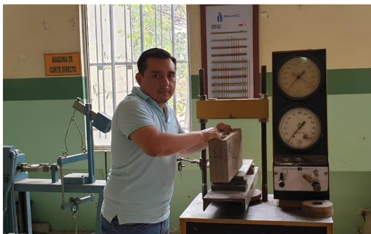
Figura 52 Pruebas de compresión Tomada por: Macancela. A & Martínez. A (2019)
