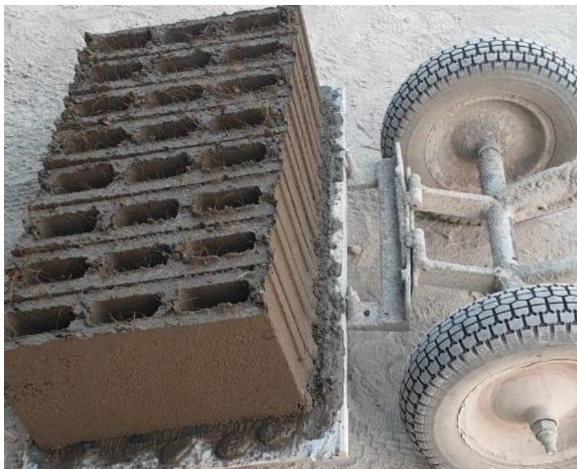
Figura 44 Desmoldado de las muestras Tomada por: Macancela. A & Martínez. A (2019)
