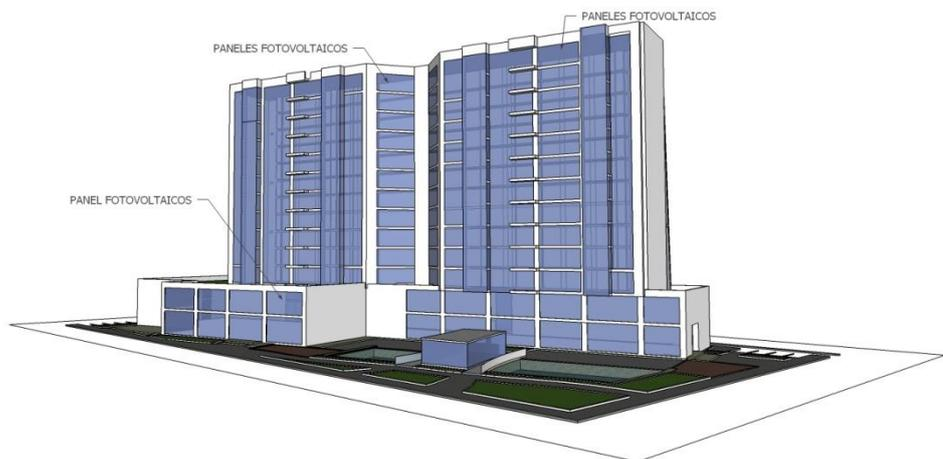
**Figura 28** Paneles fotovoltaicos
