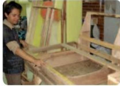
Las salas ensambladas son lijadas eliminando las imperfecciones que pudiera tener la madera, la finura del grano de los abrasivos deberá ser el adecuado; para los acabados finales el grano deberá ser fino y para los acabados de mayor tersura que requieran aristas perfectamente perfiladas, se deberá utilizar fibra metálica.
