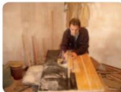
realizar el corte dimensionado de la madera, esta primera etapa de corte consiste en cortar la madera sin precisar aún la forma exacta de las piezas, para este corte se puede utilizar preferentemente una sierra circular. Posteriormente la madera dimensionada es cortada con la forma precisa de las piezas el corte se realiza preferentemente con una sierra cinta.
