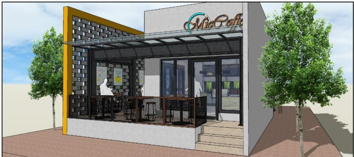
*Figura 43. Bloque con material reciclado aplicado a fachada de cafetería
