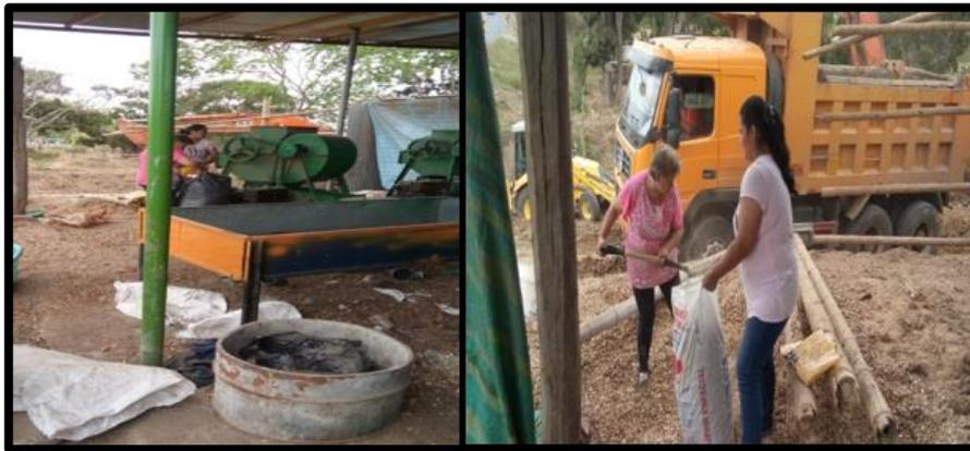
*Figura 26. Máquina para extraer la Cáscara de maní.
