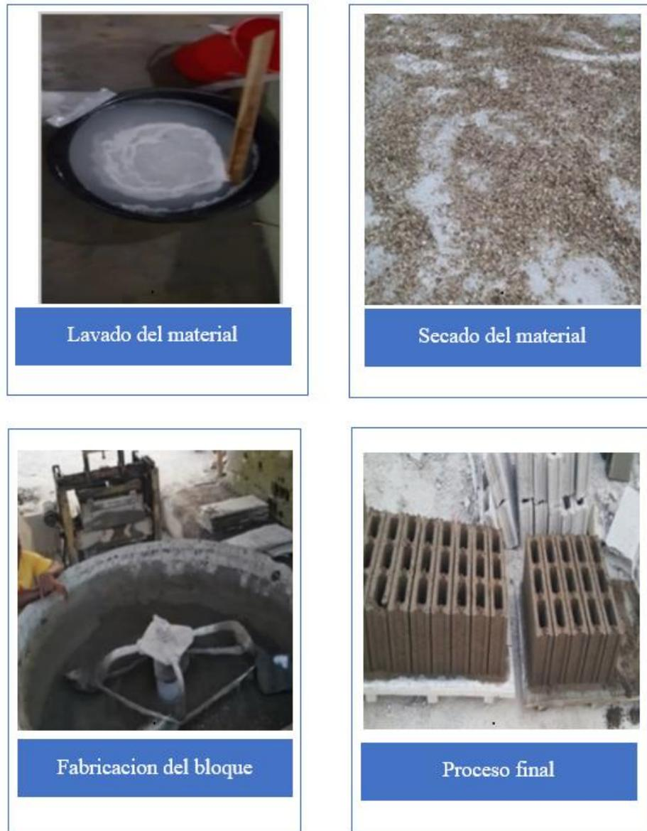
*Figura 28. Procedimiento de los bloques.
