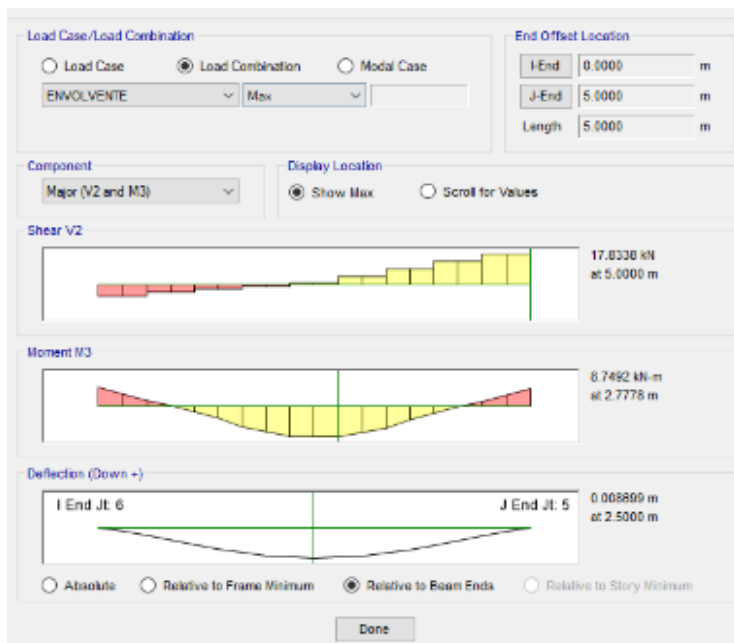
Ilustración 54. Cortante y momento 2 Fuente: ETABS (2019)
