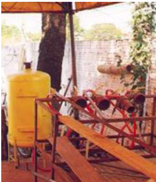
Ilustración 15. Método de Boucherie modificado Fuente: Condiciones ambientales para el desarrollo y cultivo de la guadúa (2017)
