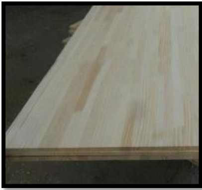
Imagen 46. Tableros de madera para moldes Elaborado por: Miranda, G & Silva, V. (2019)
