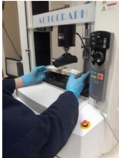
*Ilustración 56: Ensayo de Flexión
