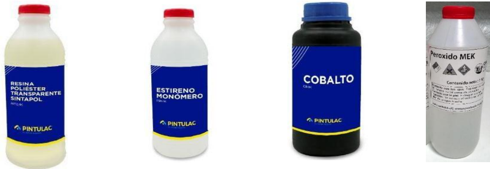
Figura 32. Resina poliéster, estireno, octoato de cobalto y peróxido Mek.
