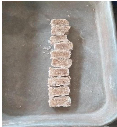
Figura 64. Probetas luego de ensayos de compresión.
