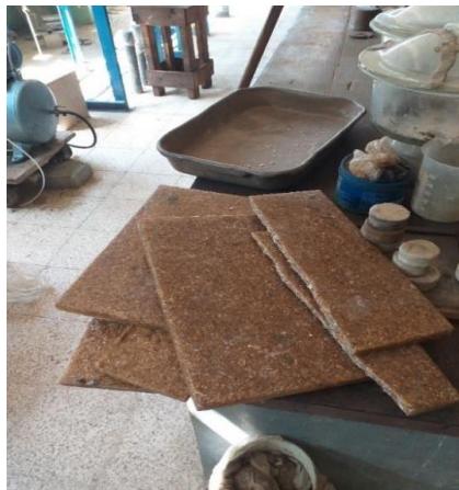
Figura 65. Moldes luego de pruebas a rotura.
