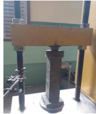
Figura 46. Probeta en máquina de compresión.
