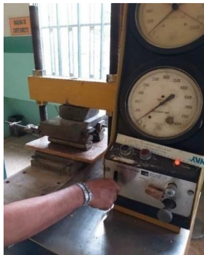
Figura 48. Prueba de flexión molde 1.
