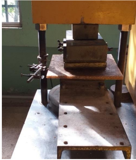
Figura 49. Prueba de flexión molde 2. Fuente: Sudario Suarez, S (2018)
