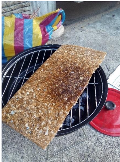
Figura 62. Prototipo luego de su exposición al fuego. Fuente: Sudario Suarez, S (2018)
