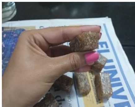
Figura 45. Probetas para pruebas de compresión.
