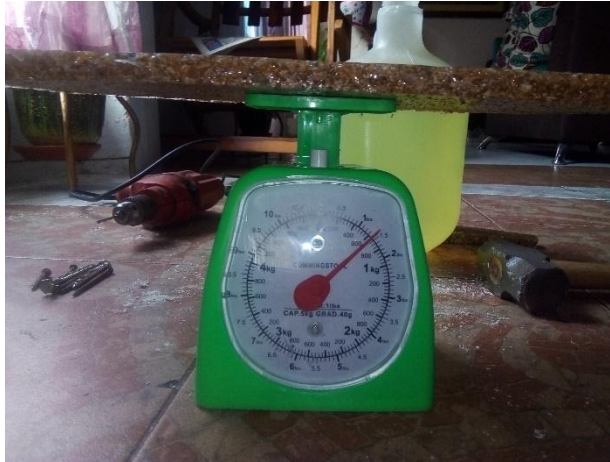
Figura 54. Peso del prototipo antes de prueba de absorción.
