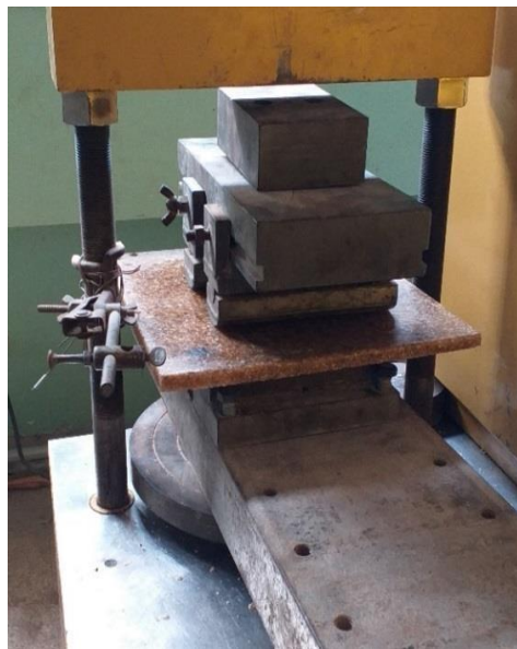
Figura 50. Prueba de flexión a molde 3. Fuente: Sudario Suarez, S (2018)
