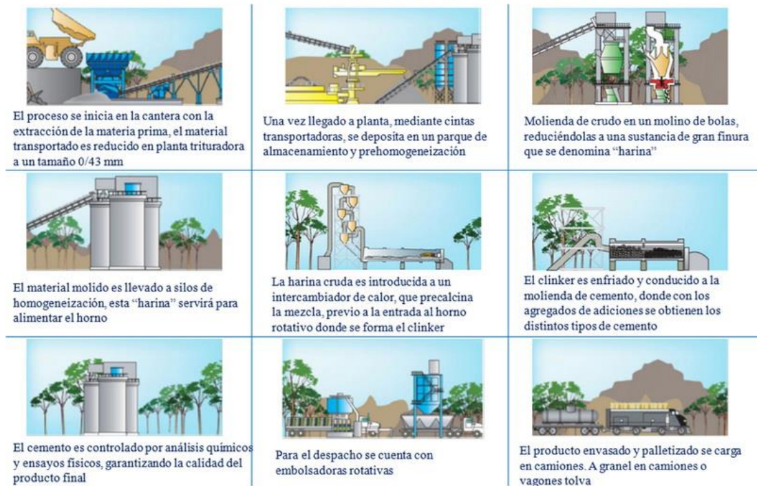
Figura 6. Fabricación de cemento Portland Fuente: Revista Vial ( 2013)
