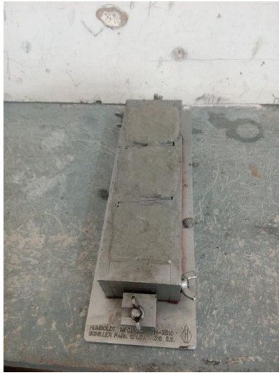
Figura 16. Muestra vertida en moldes cúbicos. Fuente: Iturralde Aldo, Rocafuerte Alexis (2019)
