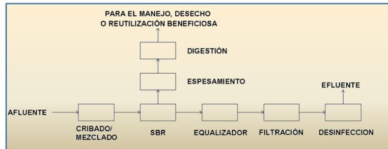
**Figura 7:** Diagrama de flujo de proceso de un Reactor Secuencial Discontinuo típico.
