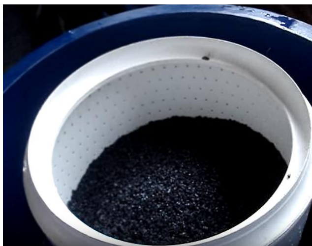
Figura 12. Secado del plástico molido Tomada por: Garrido, M. (2018)
