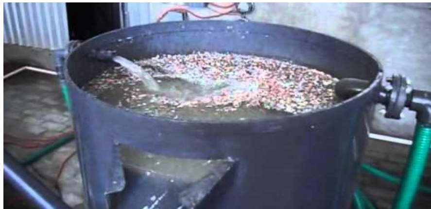
Figura 11. Lavado del plástico molido Tomada por: Garrido, M. (2018)
