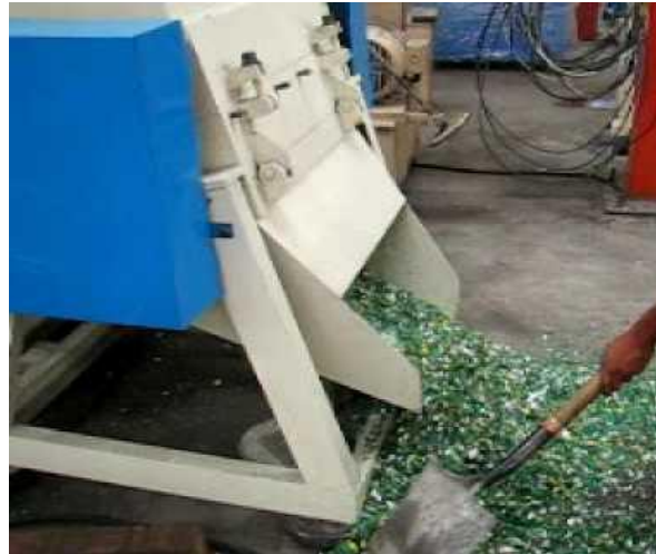
Figura 10 Moliendo del plastico Tomada por: Garrido, M. (2018)
