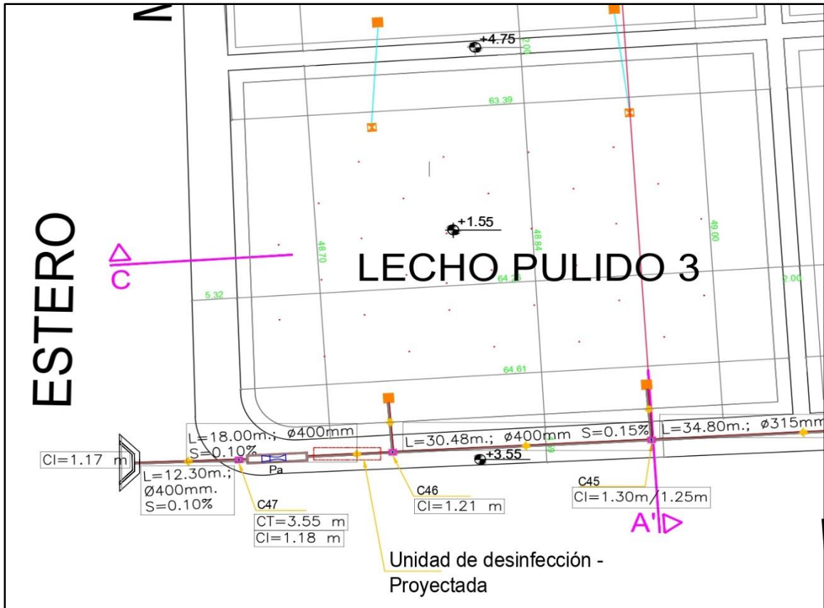
Figura 45: Unidad de desinfección proyectada
