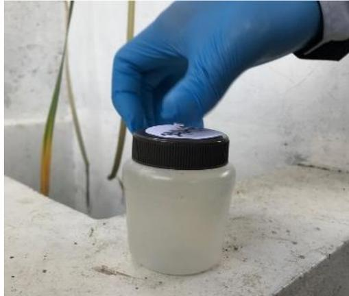
**Ilustración 29.** Toma de muestra del agua residual tratada, a la salida de la planta piloto.
