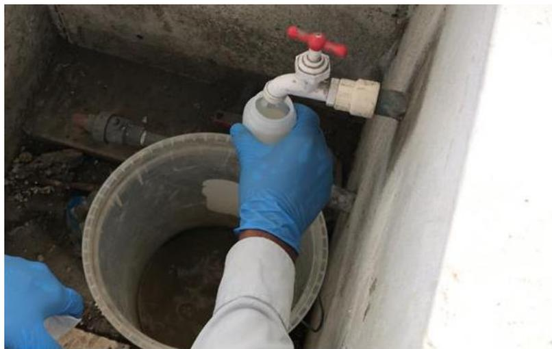
**Ilustración 18.** Toma de muestra, a la salida de la planta piloto
