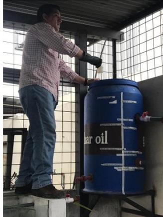
**Ilustración 28.** Toma de muestra del agua residual, a la entrada del tanque elevado.
