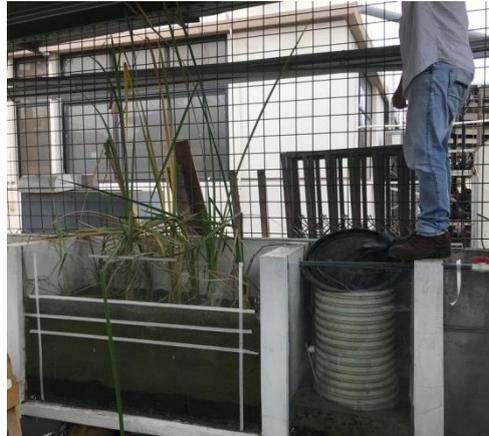
**Ilustración 24.** Prueba con una altura de 45cm de zeolita.
