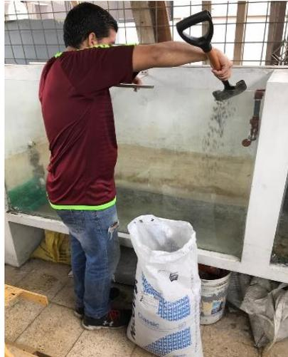
**Ilustración 10.** Colocación de piedra 1/8
