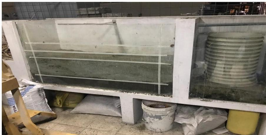
**Ilustración 31.** Acondicionamiento para toma de última muestra con altura de 25cm de zeolita.
