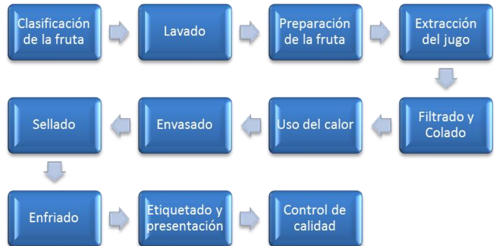
GRÁFICO 24: PROCESO PARA PRODUCIR EL CONCENTRADO DE PAPAYA ELABORADO POR: SHIRLEY ESPINDOLA – JENNIFFER LOOR
