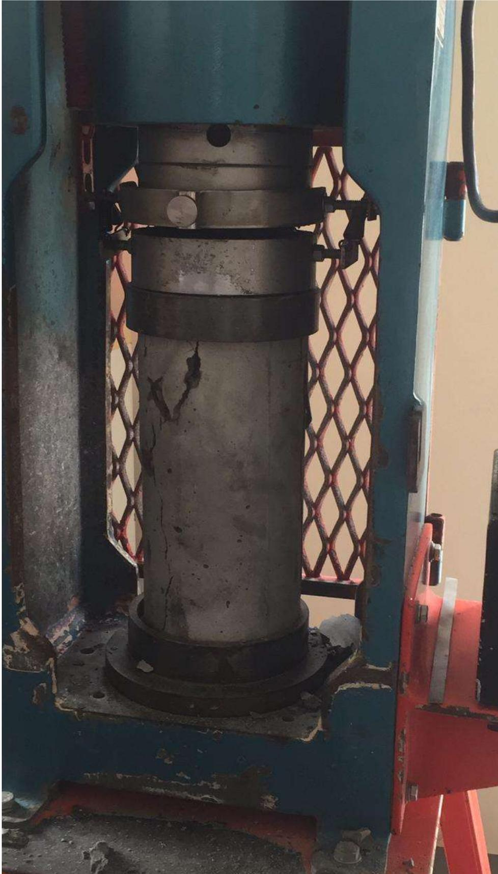
Rotura de cilindro en máquina de compresión simple
