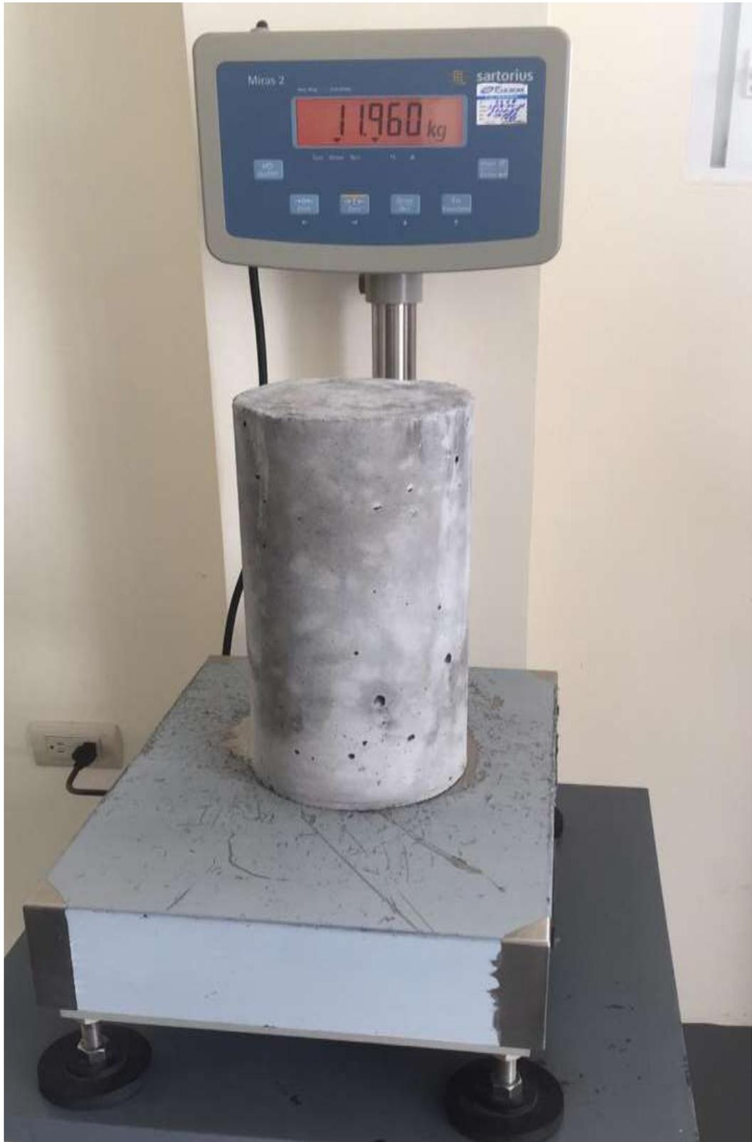
Peso de cilindro, antes de rotura a compresión
