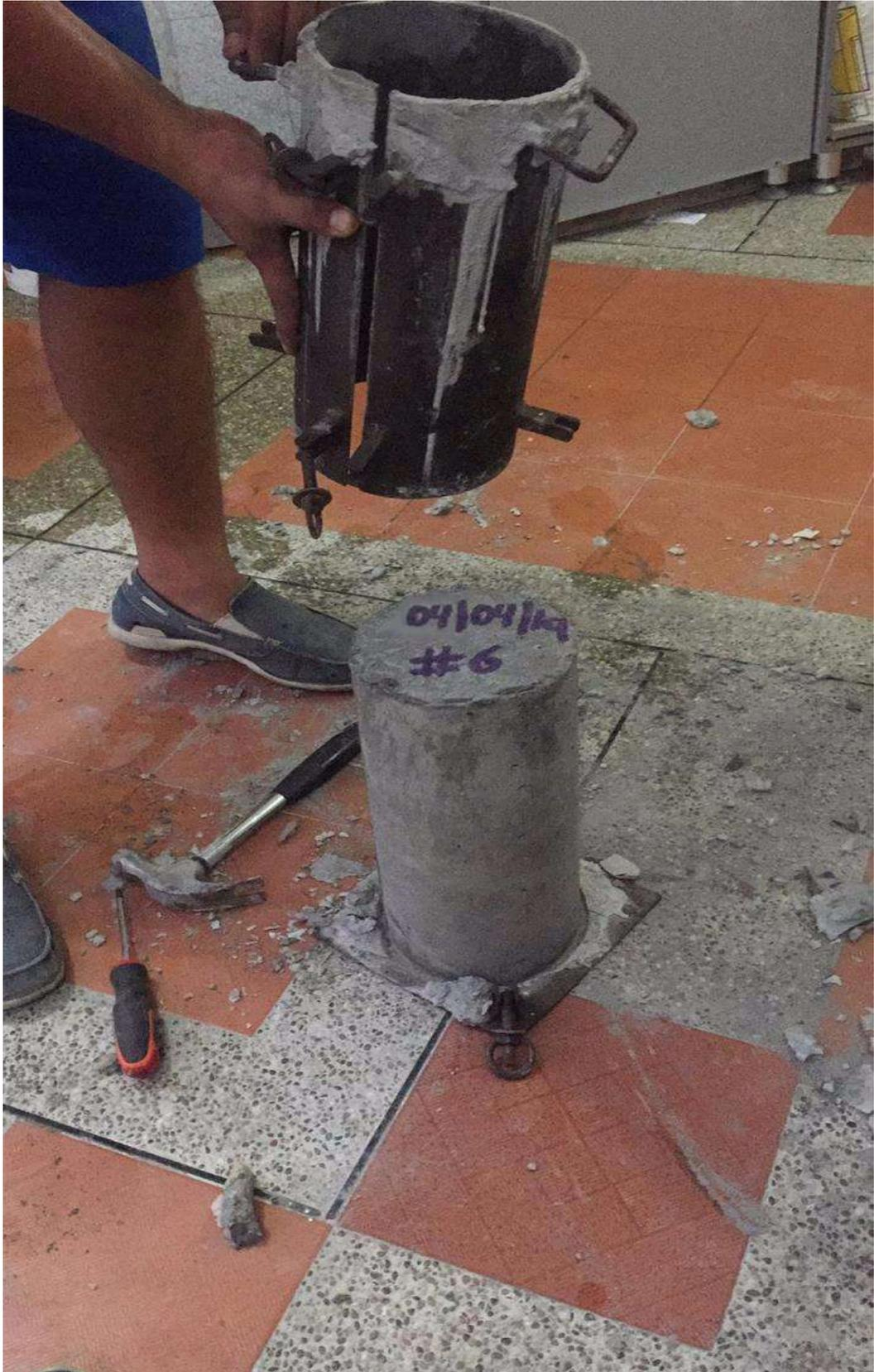
Extracción de probetas con fechas de elaboración
