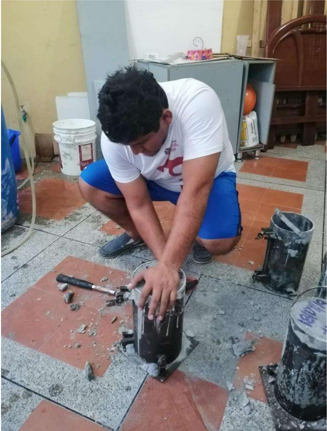
Extracción de probetas
