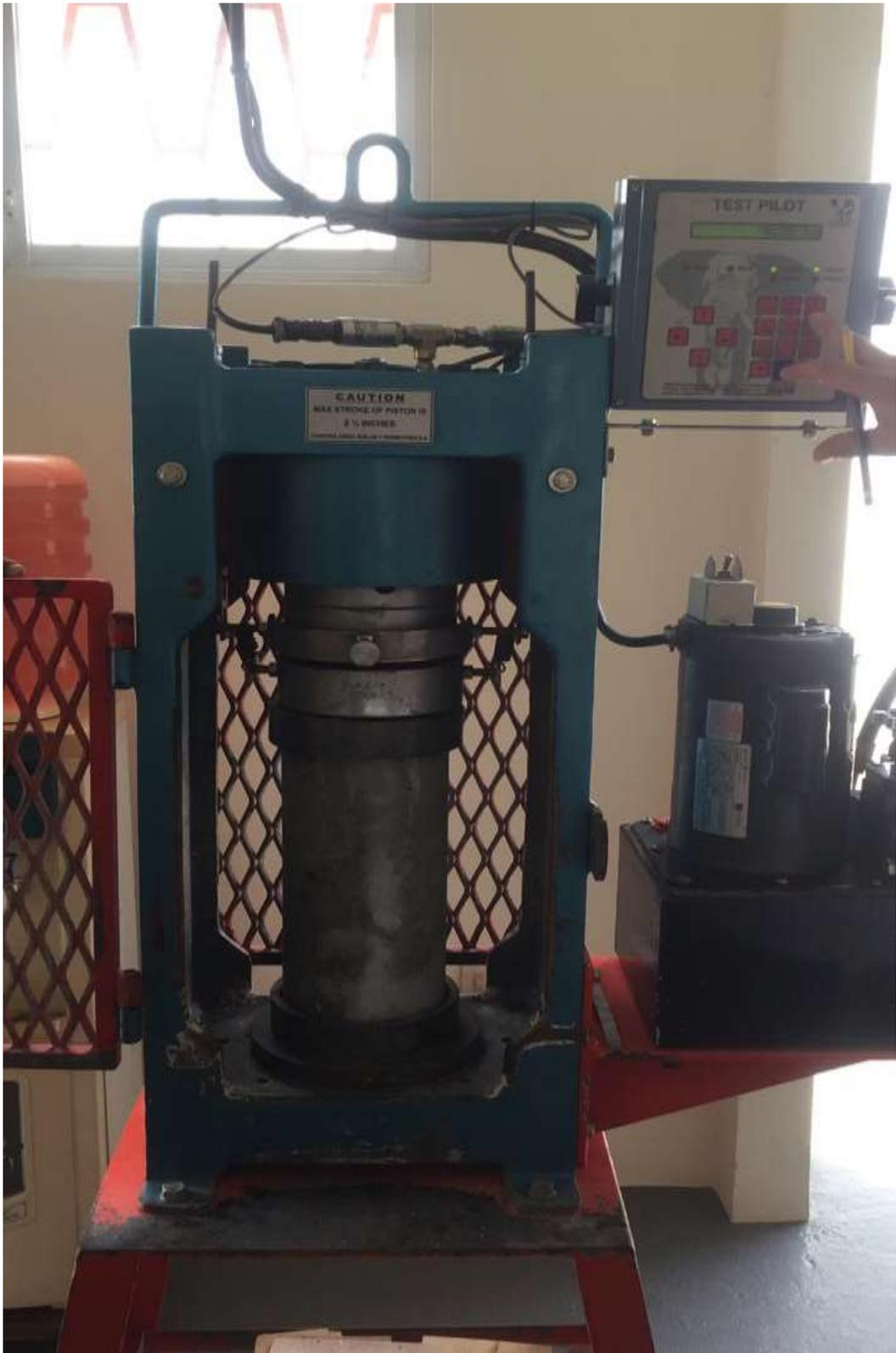
Colocación de cilindro en máquina de compresión simple
