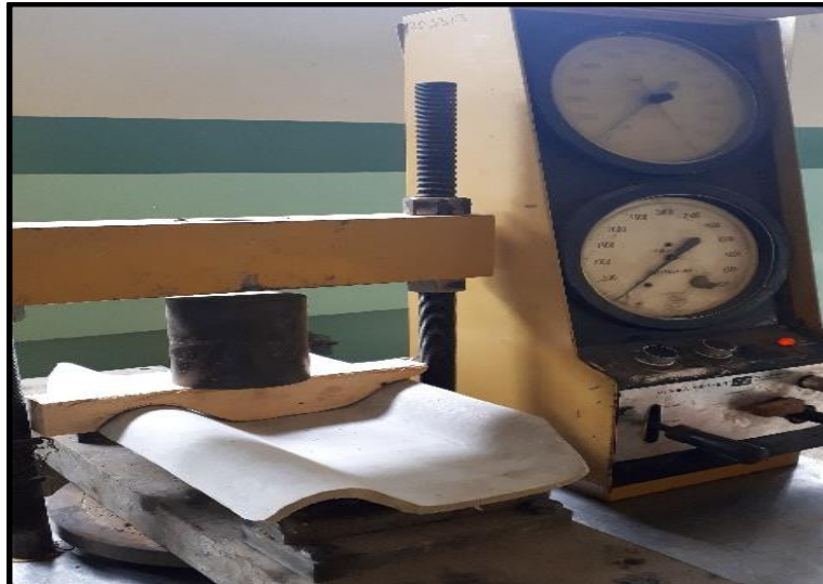
Ilustración 42: Ensayo de Resistencia a la Flexión. Elaborado por: Lopez Arana, V & Muquinche Supe, L (2019).
