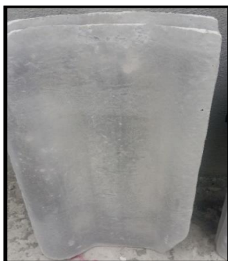
Ilustración 57: Ensayo de Porosidad y Fisuración. Elaborado por: Lopez Arana, V & Muquinche Supe, L (2019).
