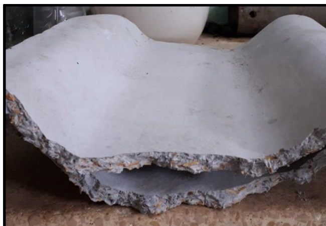
Ilustración 62: Ensayo de Resistencia a la Flexión.
