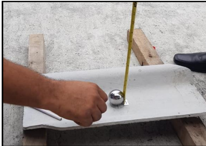
Ilustración 41: Ensayo de Impacto a la Rotura. Elaborado por: Lopez Arana, V & Muquinche Supe, L (2019).
