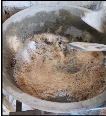
Ilustración 46: Mezcla con PET y cáscara de arroz molida. Elaborado por: Lopez Arana, V & Muquinche Supe, L (2018).
