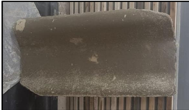
Ilustración 52: Prototipo 6 con manchas de humedad.. Elaborado por: Lopez Arana, V & Muquinche Supe, L (2018).
