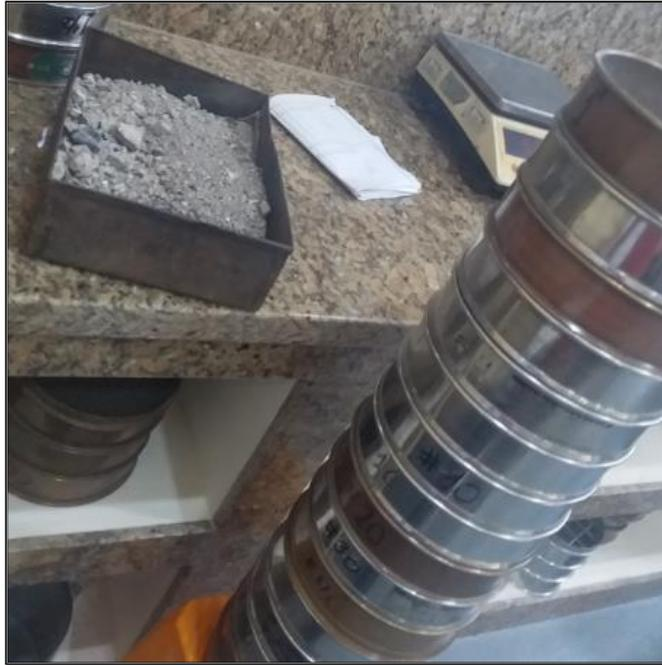
*Figura 26.* Colocación de la muestra en los tamices
