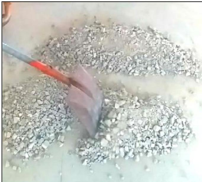
*Figura 17.* Toma de una de partes y dividida en dos nuevamente
