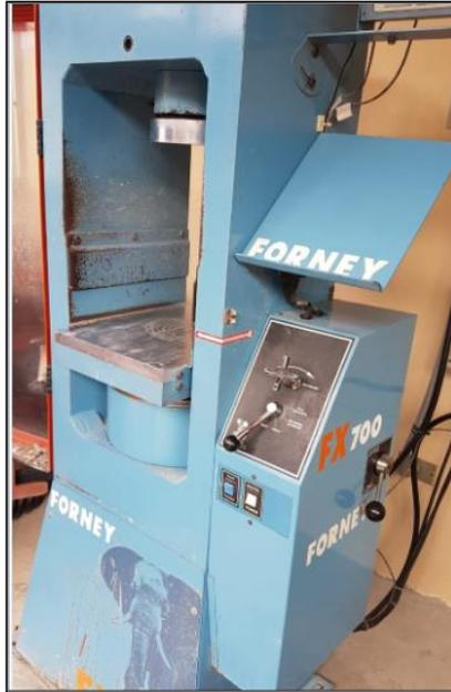
*Figura 43.* Máquina para ensayo a la compresión simple
