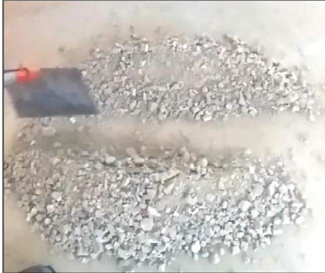
*Figura 16.* Proceso de división de la Muestra de bloques y baldosas separado en dos partes
