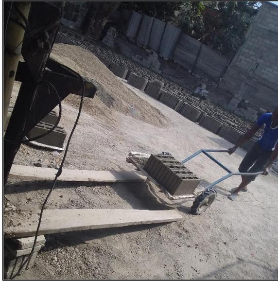
*Figura 37.* Retiro de los bloques para el fraguado
