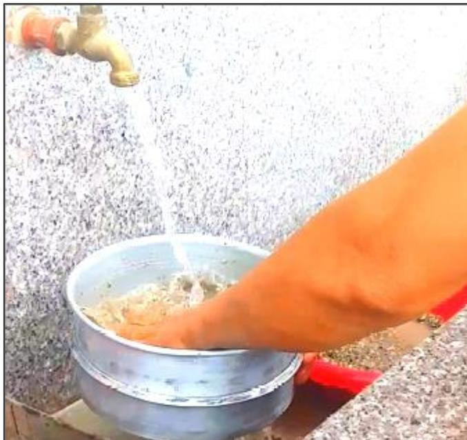
*Figura 19.* Lavado del material por el tamiz 200mm
