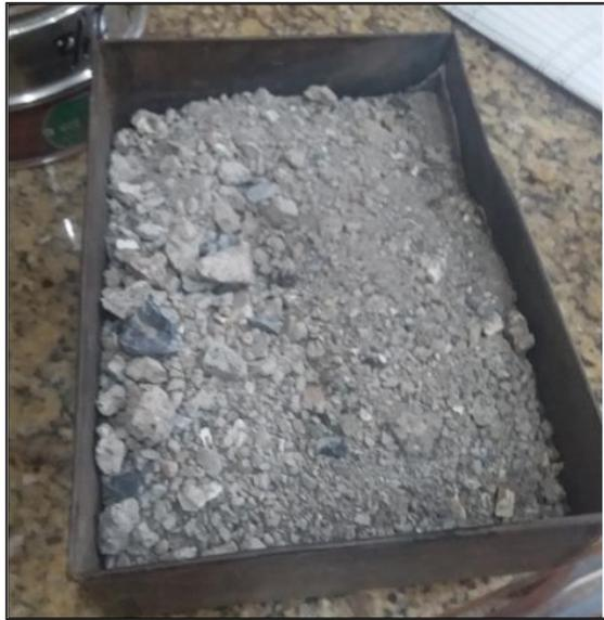
*Figura 22.* Muestra retirada del horno para su enfriamiento
