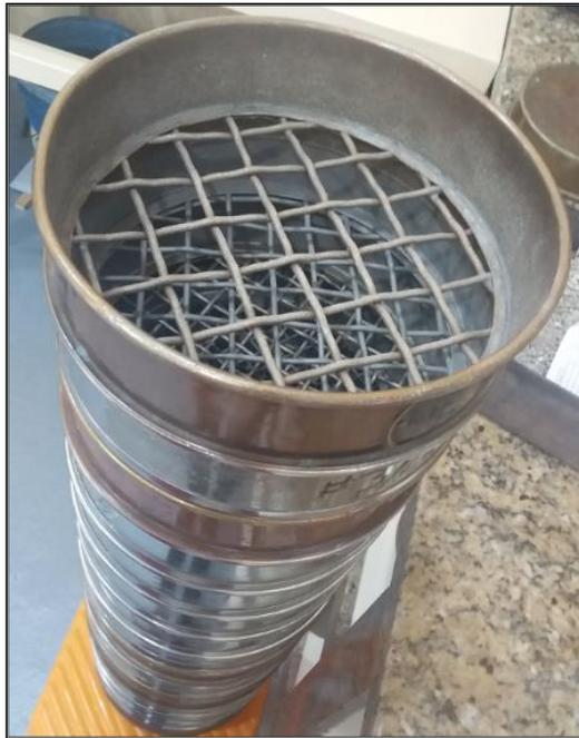
*Figura 25.* Tamices listo para el proceso de tamizado
