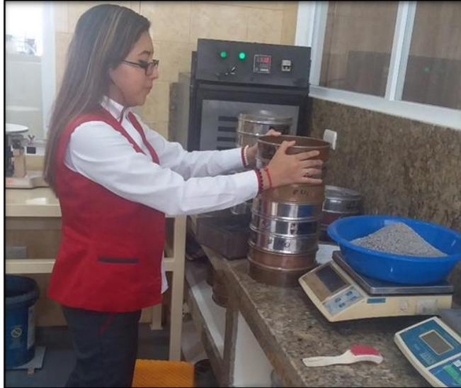
*Figura 24.* Colocación de todos los tamices en forma descendente
