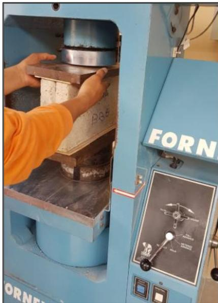
*Figura 44.* Colocación del bloque en la máquina de ensayo a la compresión simple
