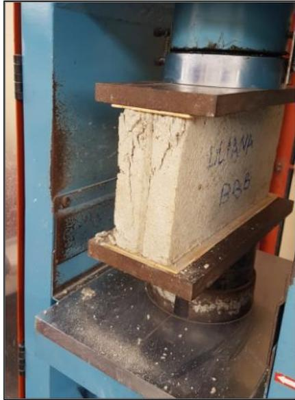
Figura 45. Rotura del bloque
