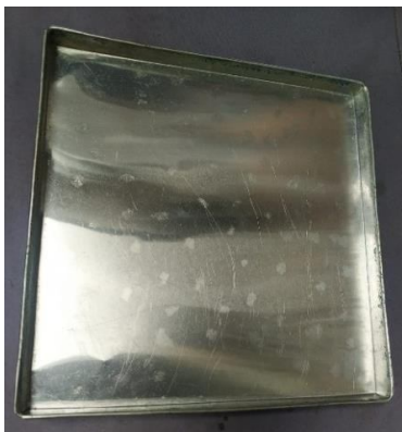
Figura 12. Molde de aluminio de 30x30 Fuente: Elaborado por Domínguez G, & Velasco L.
