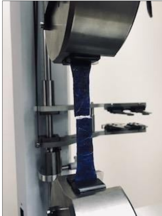
Figura 52. Prueba de esfuerzo a tensión Fuente: Elaborado por Domínguez G, & Velasco L.
