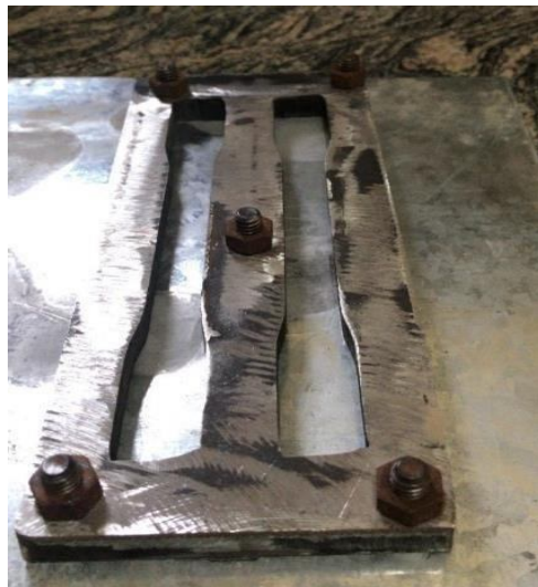
Figura 33. Molde de acero mejorado con tornillos. Fuente: Elaborado por Domínguez G, & Velasco L.
