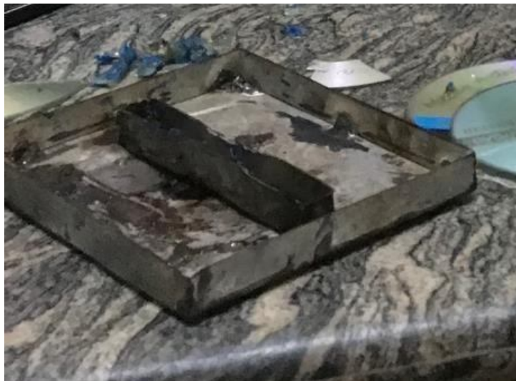
Figura 21. Molde fabricado en acero con base de agarre para mejor manipulación Fuente: Elaborado por Domínguez G, & Velasco L.
