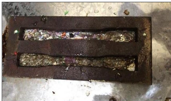
Figura 34. Molde de acero materia prima. Fuente: Elaborado por Domínguez G, & Velasco L.
