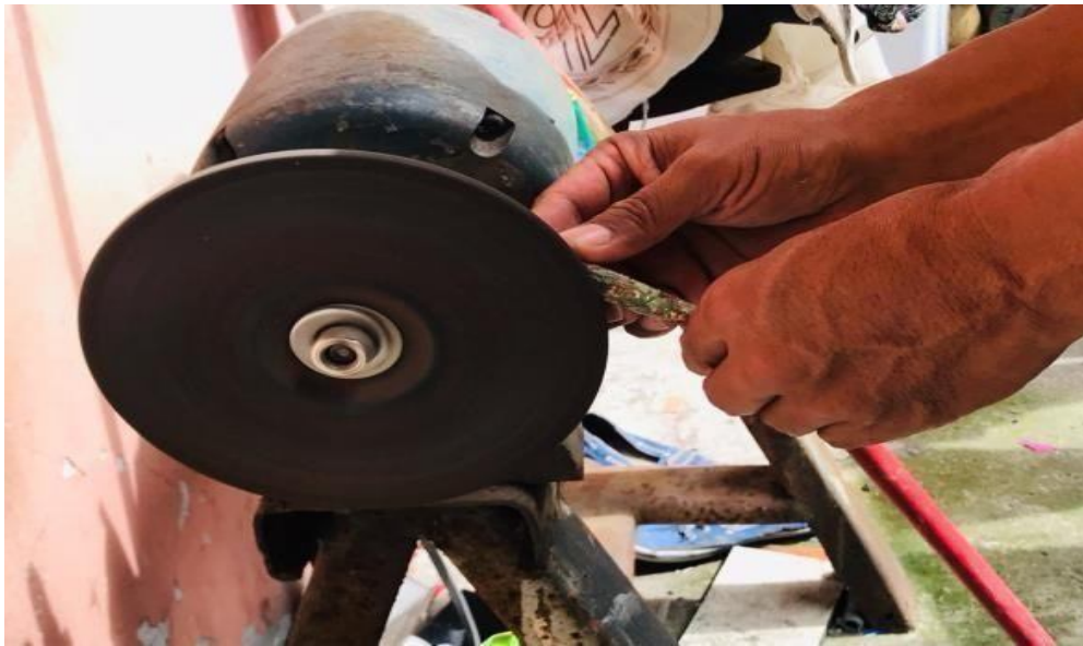
Figura 29. Muestras pulidas en esmeril Fuente: Elaborado por Domínguez G, & Velasco L.
