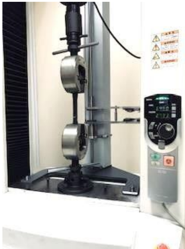
Figura 51. Máquina de alta tecnología, de marca Shimadzu, modelo: AG-IS-10- KN, serie: 346-51961-01 Elaborado por Domínguez G, & Velasco L.
