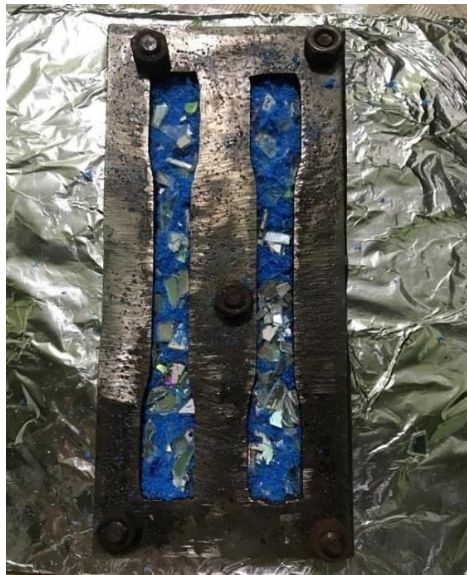
Figura 42 Molde con sus prototipos realizados en horno eléctrico Fuente: Elaborado por Domínguez G, & Velasco L.
