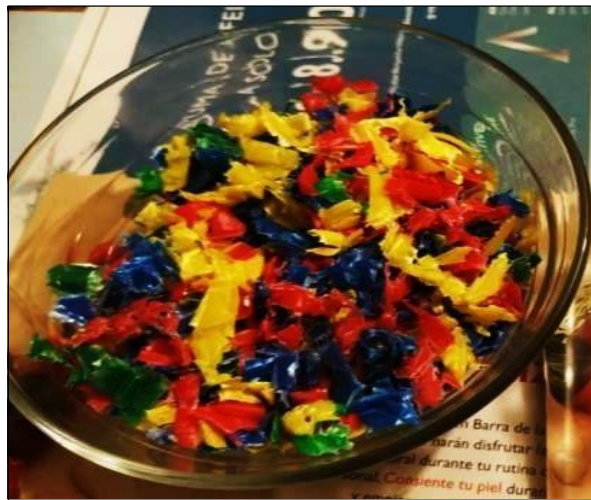
Figura 25. Tapas de plástico triturados con tijera industrial Fuente: Elaborado por Domínguez G, & Velasco L.
