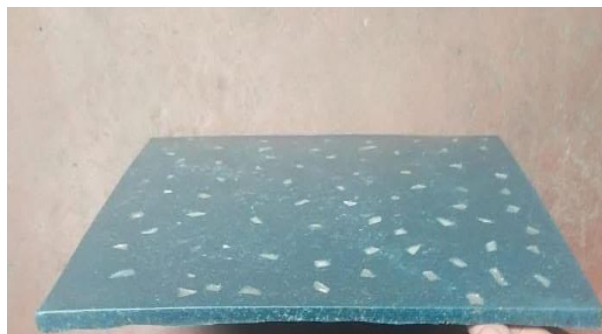
Figura 50. Lámina de 0,45 x0,45 con espesor de 6mm Fuente propia
