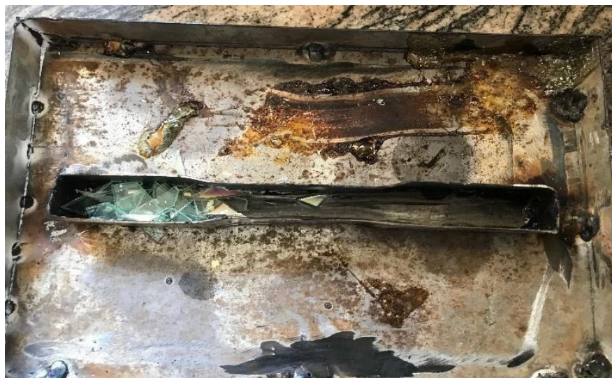
Figura 22. Molde fabricado en acero vista en planta Fuente: Elaborado por Domínguez G, & Velasco L.
