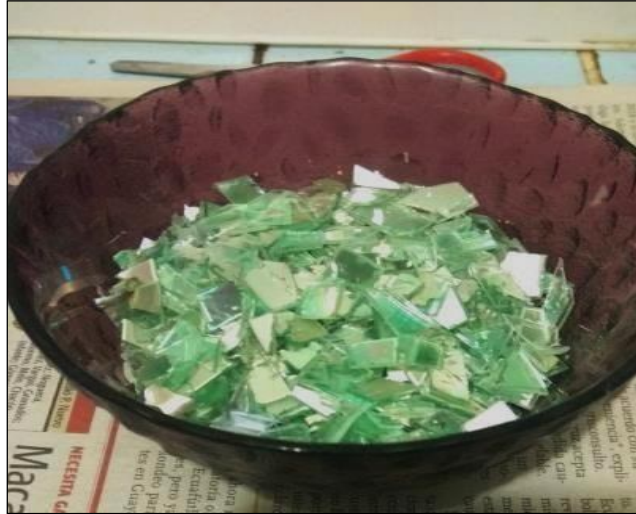
Figura 24. Cds triturados con tijera industrial Fuente: Elaborado por Domínguez G, & Velasco L.
