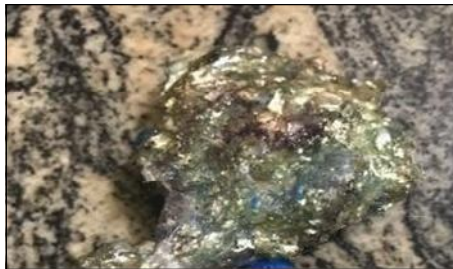
Figura 19. Primera muestra fallida fundida en sartén a fuego lento Fuente: Elaborado por Domínguez G, & Velasco L.
