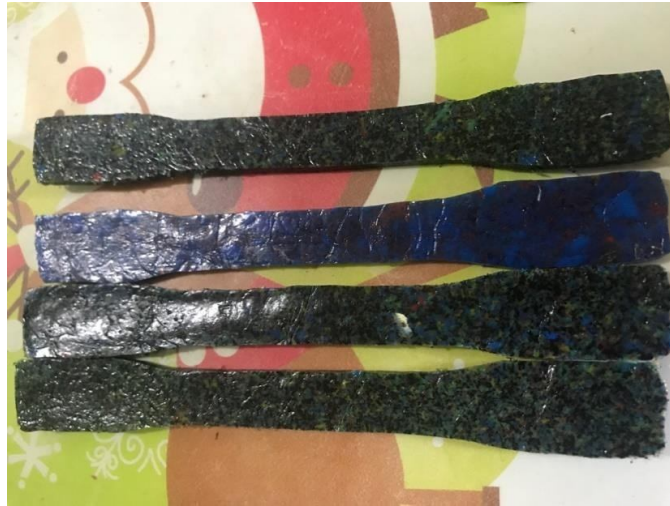
Figura 42. Prototipos de esta fase no aptas para realizar pruebas mecánicas Elaborado por Domínguez G, & Velasco L.
