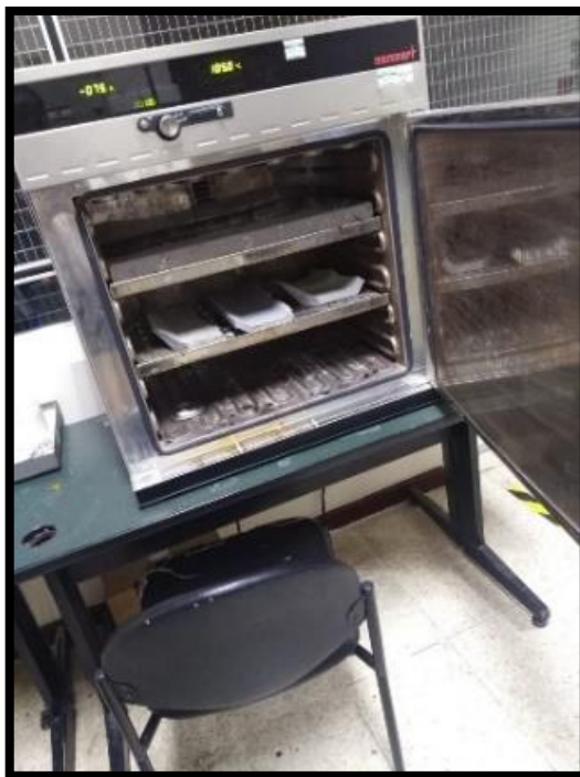
Ilustración 47. Ensayo de absorción en teja 3 Elaborado por: Lozano Zamora, K (2019)
