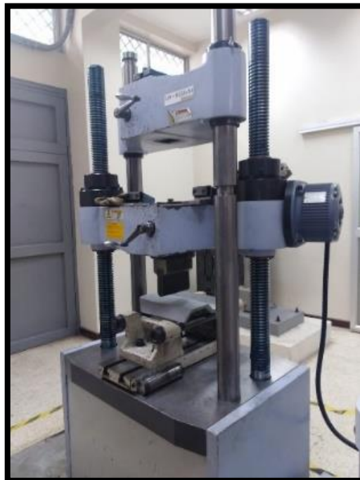
Ilustración 45. Ensayo de flexión en teja 4 Elaborado por: Lozano Zamora, K (2019)
