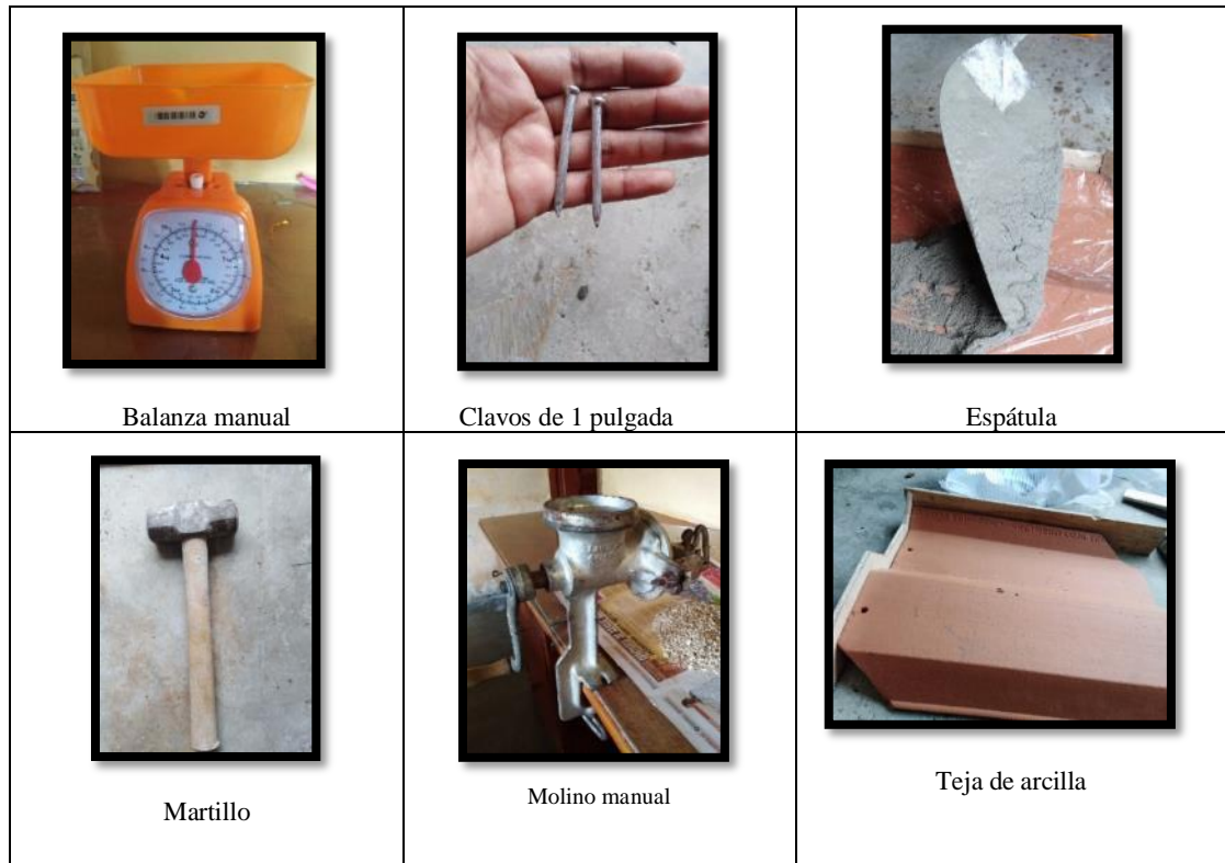
Ilustración 24. Herramientas para la fabricación de la teja Elaborado por: Lozano Zamora, K (2019)
