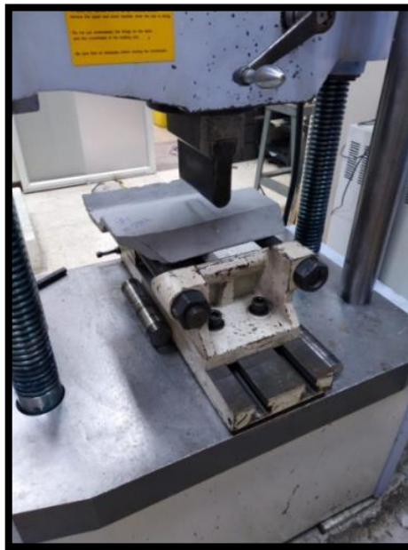
Ilustración 43. Ensayo de flexión en teja 2 Elaborado por: Lozano Zamora, K (2019)
