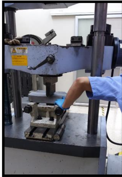
Ilustración 44. Ensayo de flexión en teja 3 Elaborado por: Lozano Zamora, K (2019)
