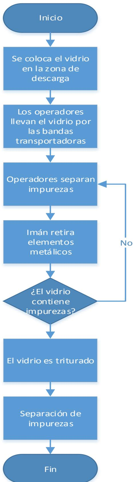
**Figura 27.** Proceso de separado, limpiado y triturado de vidrio
