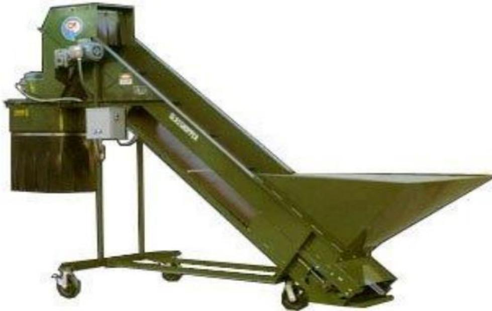
*Figura 20. Maquina trituradora de vidrio*
