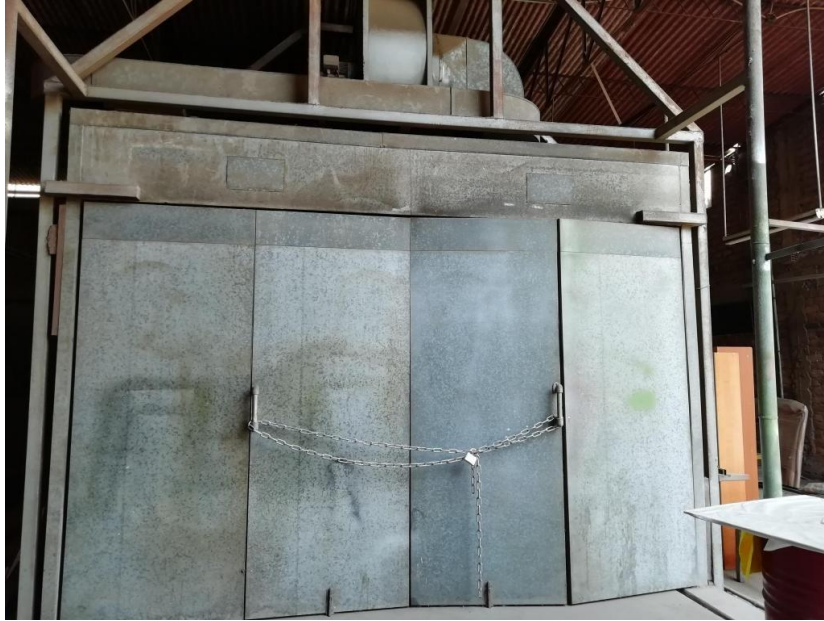
Figura 4. Horno para secar la madera nacional para garantizar el producto final. Fuente: “Rediseño de los procesos de despachos de tableros laminados en Novocentro la Perimetral” Elaborado por: Quimí Ronquillo, Yuliana,
