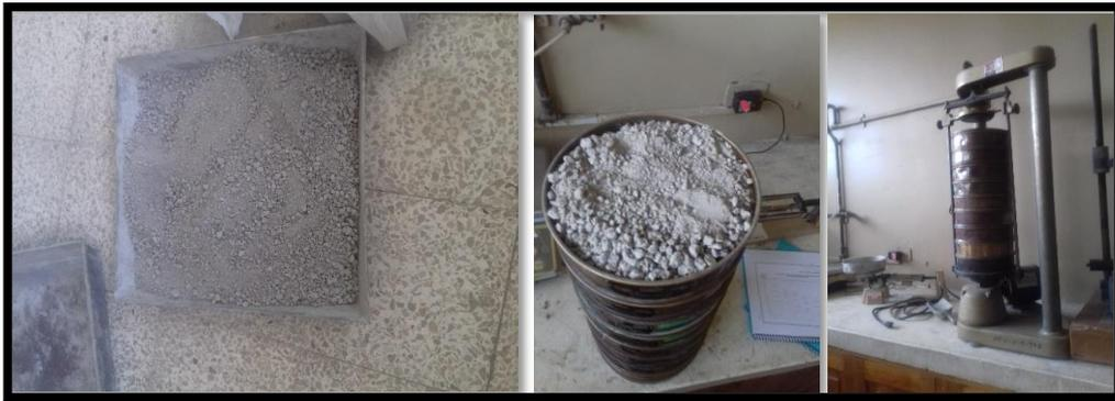
*Imagen 27.* Ensayo granulométrico
