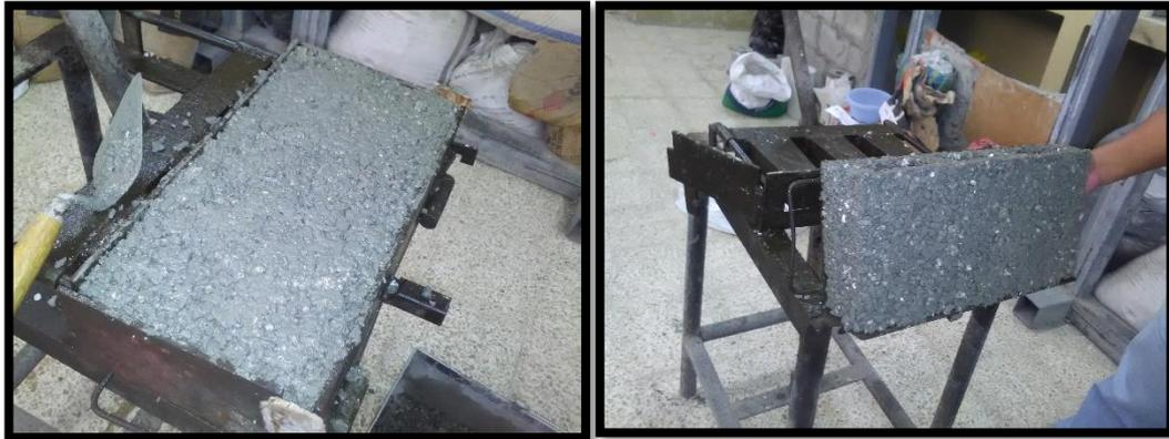
**Imagen 34.** Obtención de muestra fallida
