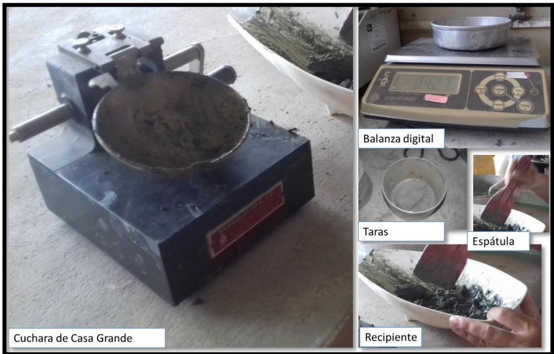
**Imagen 29.** Herramientas para realizar prueba de Límite líquido
