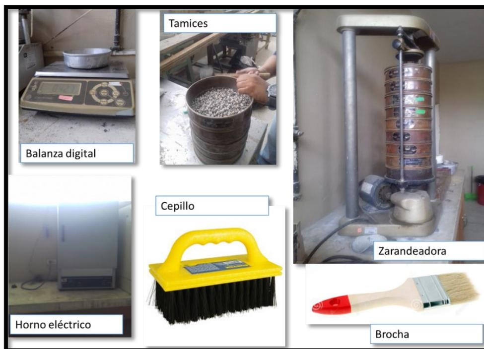
**Imagen 26.** Ensayo granulométrico
