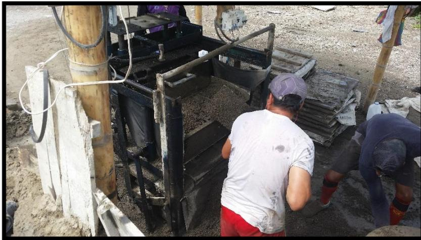
**Imagen 37.** Vertido de la mezcla en la bloquera
