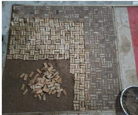
Figura 33: Vertido la mezcla en un molde de madera Elaborado por: Borja Jiménez, K. & Castillo Moya, N. (2019)
