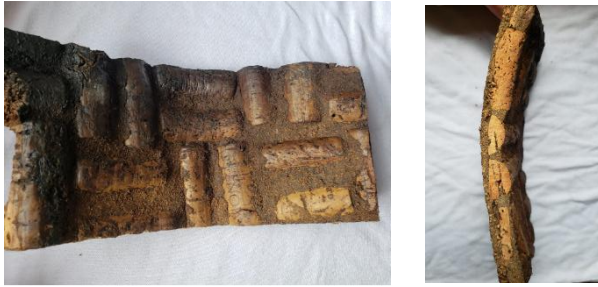
Figura 46: Prueba de resistencia a la flexión Elaborado por: Borja Jiménez, K. & Castillo Moya, N. (2019)
