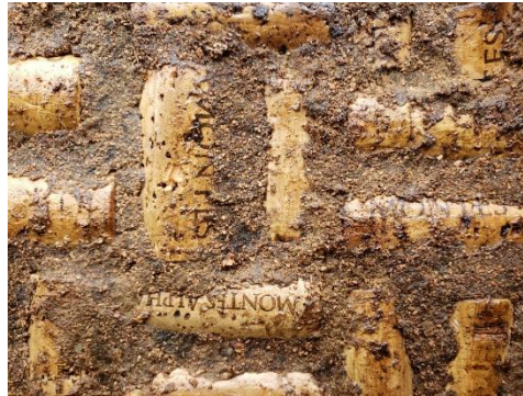
Figura 39: resultado del sellado acrílico Elaborado por: Borja Jiménez, K. & Castillo Moya, N. (2019)
