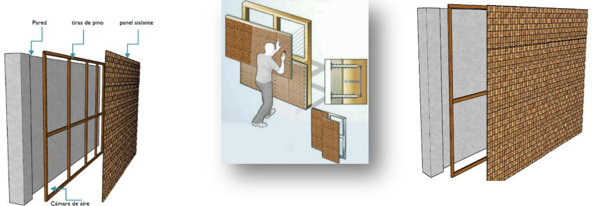
Figura 53: Instalación en revestimiento de pared Elaborado por: Borja Jiménez, K. & Castillo Moya, N. (2019)
