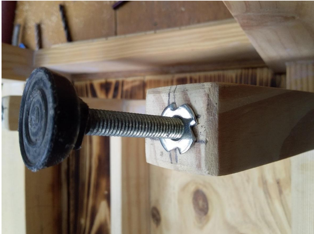
Figura 20. Se colocan los niveladores. Elaborado por: Morán Rivas, K (2018)
