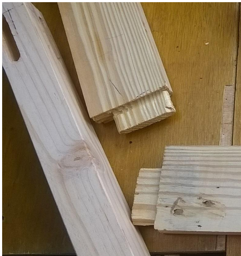
Figura 15. Se realizan los cortes y los ensambles para el mobiliario en ese caso caja y espiga. Elaborado por: Morán Rivas, K (2018)
