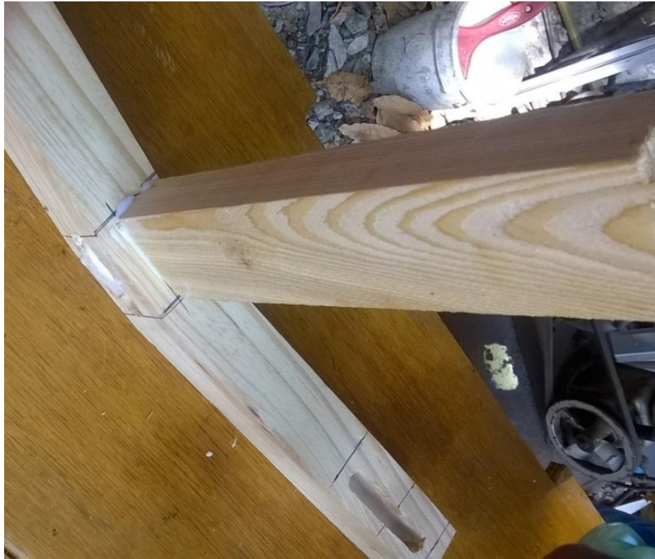
Figura 16. Se procede al encolado y ensamblado. Elaborado por: Morán Rivas, K (2018)
