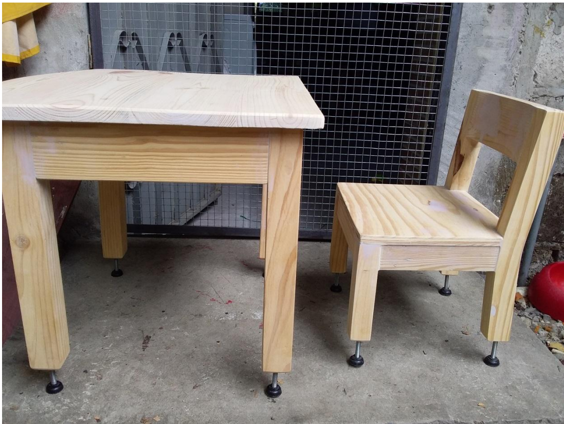
Figura 32. Mesa y silla con niveladores, previo al proceso de sellado y pintado. Elaborado por: Morán Rivas, K (2018)
