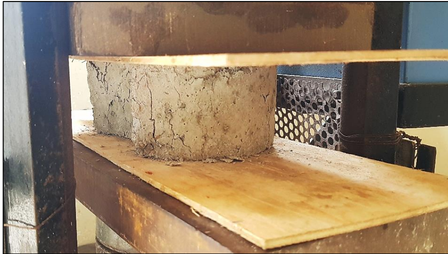
Ilustración 52: Ensayo de compresión en adoquín 5 Elaborado por: Fierro Muñoz José, (2019)
