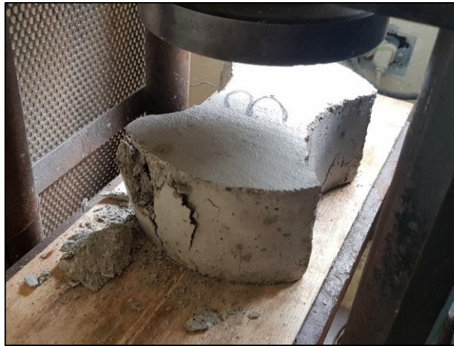
Ilustración 50: Ensayo de compresión en adoquín 3 Elaborado por: Fierro Muñoz José, (2019)
