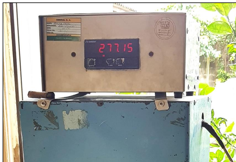
Ilustración 53: Resultado de ensayo de compresión en adoquín 5 Elaborado por: Fierro Muñoz José, (2019)
