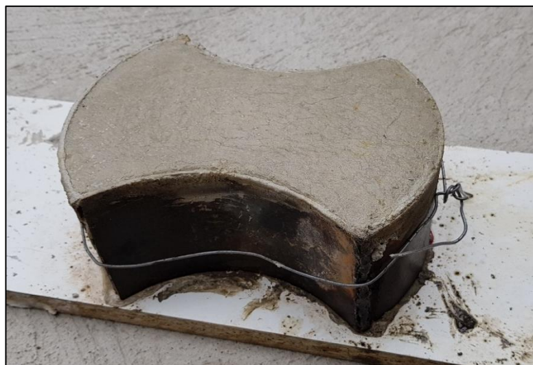
Ilustración 45: Desmolde del adoquín 5 Elaborado por: Fierro Muñoz José, (2019)
