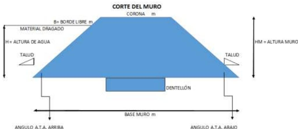
Figura 1 Corte transversal del muro de confinamiento
