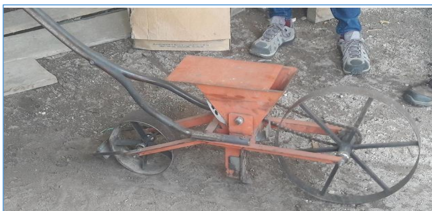
Figura 6. Maquinaria para siembra de semilla de amaranto Fuente: Bohórquez Lissette; Burbano, Cinthia (2018).
