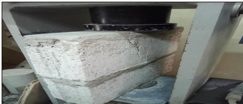
*Figura: 80 Compresión Axial en Pilas de Bloques*
