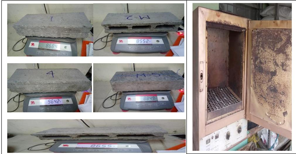
**Figura: 57** Peso y Secado al horno de Mampuestos.
