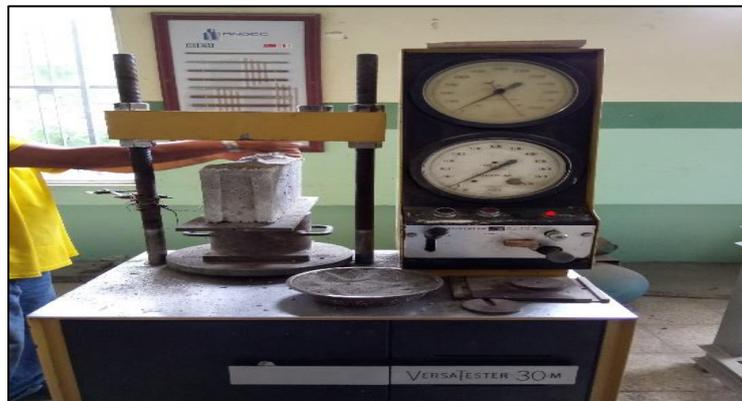
**Figura: 71** Máquina de compresión semiautomática
