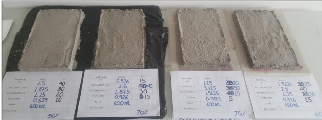
Figura: 34 Dosificaciones con cal hidratada sin cemento
