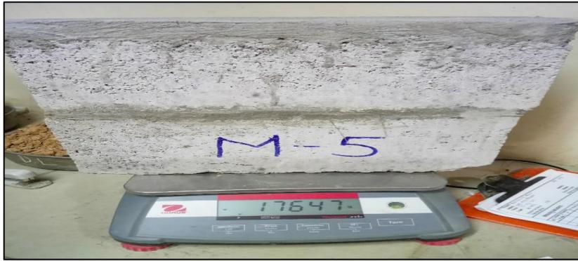
**Figura: 81** Pesado de las pilas de bloques previo rotura axial.
