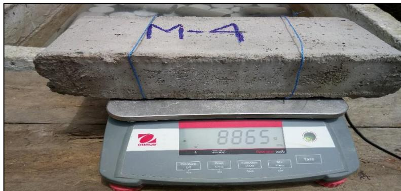
**Figura: 61** Peso de Mampuestos Superficialmente Seco
