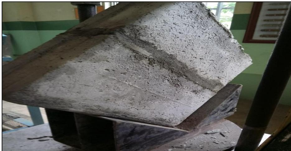
**Figura: 87 Colocación del Murete en el Ángulo de compresión metálico**
