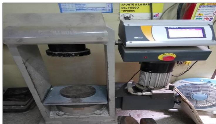
**Figura: 72** Máquina de compresión automática
