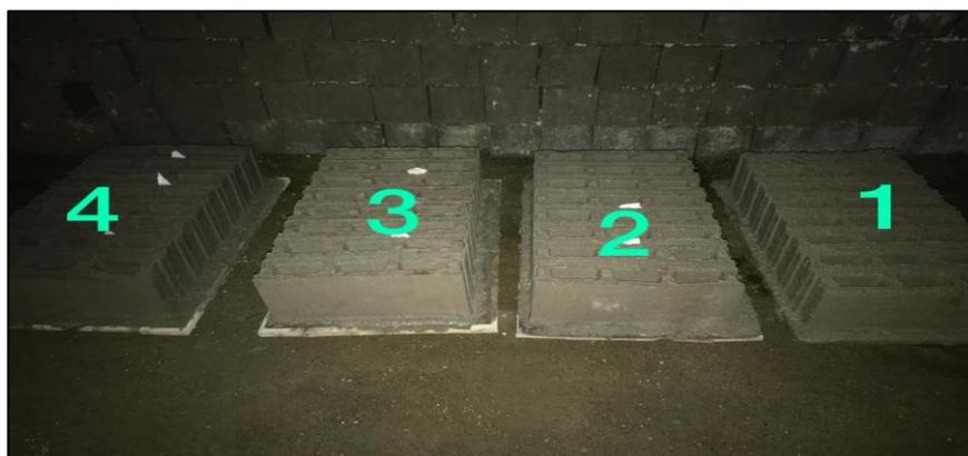
**Figura: 35 Bloques con Dosificaciones con cemento**
