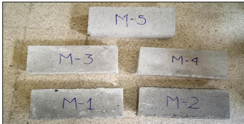
*Figura: 67 Muestras de Bloques para ensayo compresión simple.*
