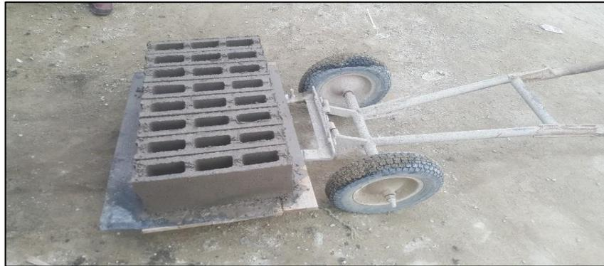
*Figura: 42 Bloques salido de la prensa*
