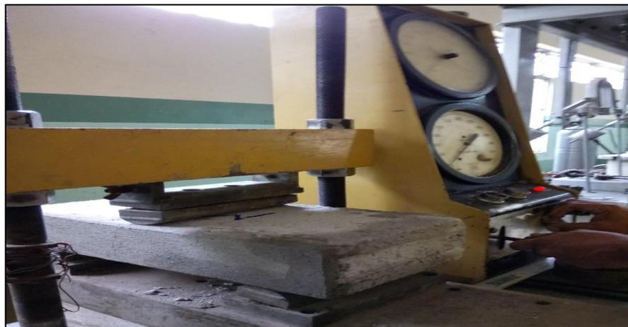
*Figura: 83 Colocación del bloque en apoyos para ensayo de flexión*
