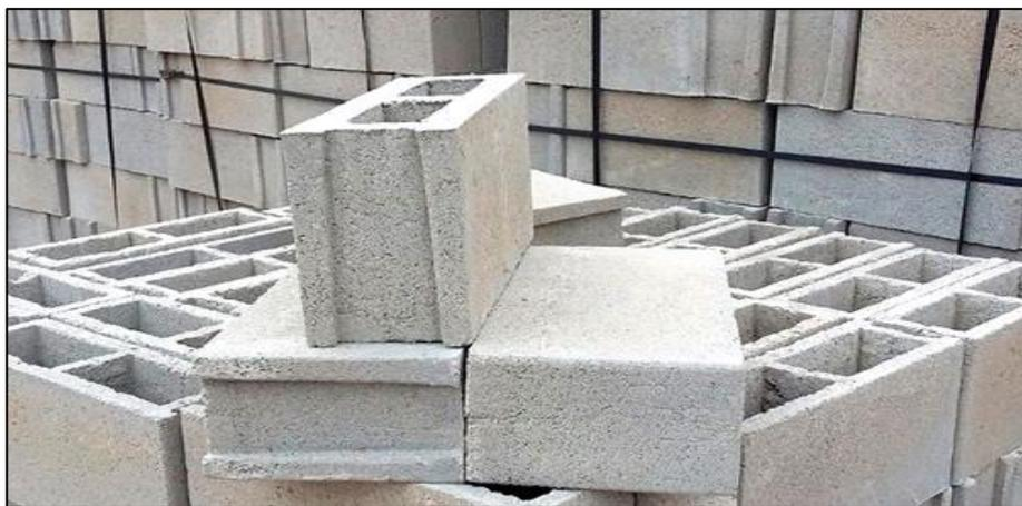
*Figura: 5 Bloques de escombros de la Empresa Constructora Holguín.
