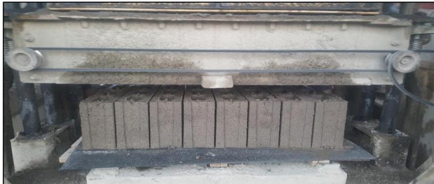
**Figura: 41 Salida de Bloques de los moldes**
