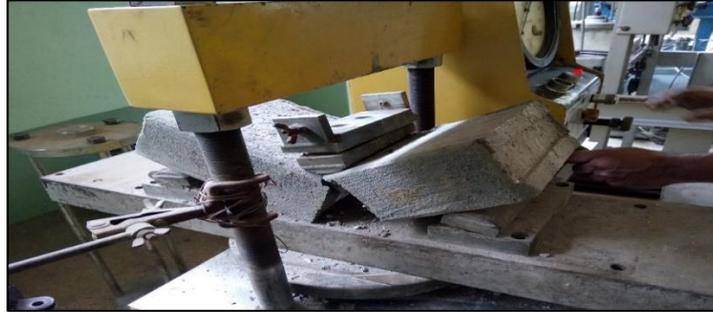
*Figura: 84 Rotura de Bloque ante esfuerzo de flexión.
