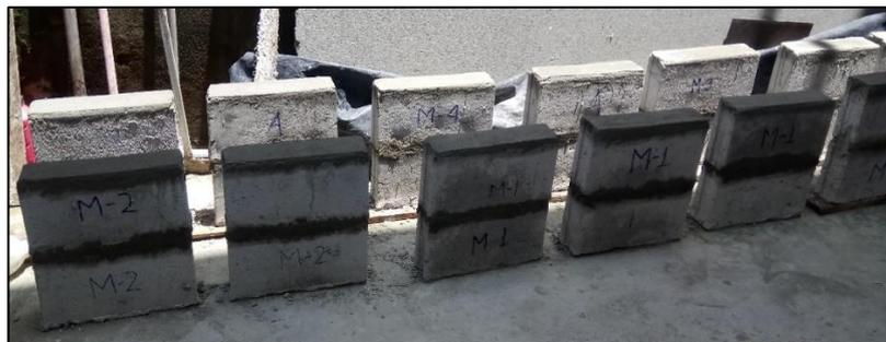
*Figura: 78 Pilas de Bloque con la unión de dos mampuestos.*
