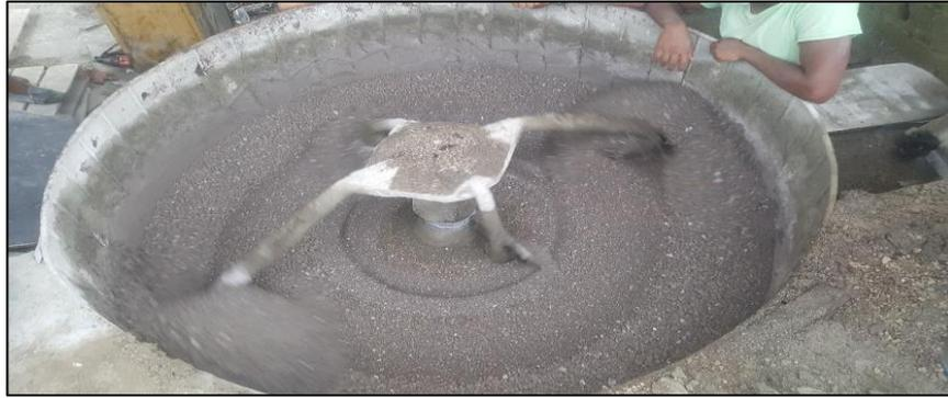
**Figura: 36 Tambor de Mezclado de agregados**
