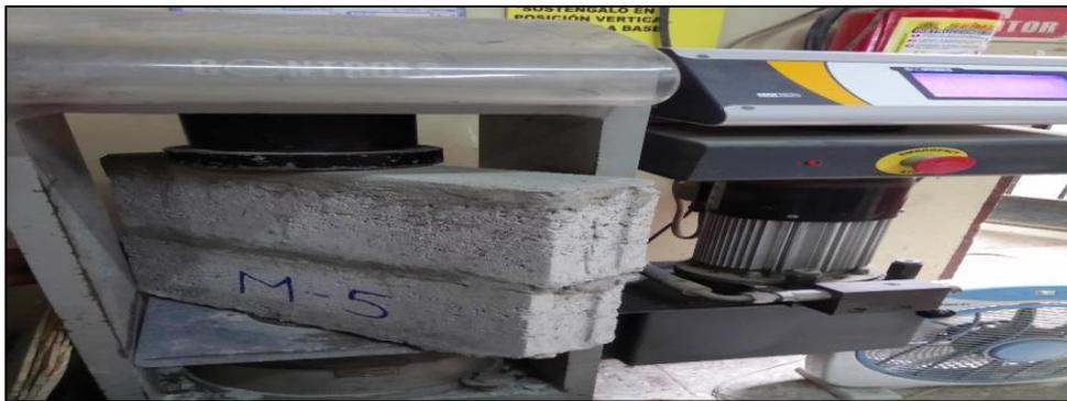
*Figura: 79 Colocación de Pilas de bloque para ensayo de compresión axial.*
