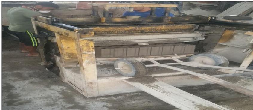
**Figura: 40 Bloquera semi hidráulica con molde de 39x19x9 cm**
