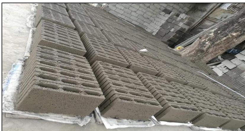
*Figura: 12 Bloque victoria puesto al secado*
