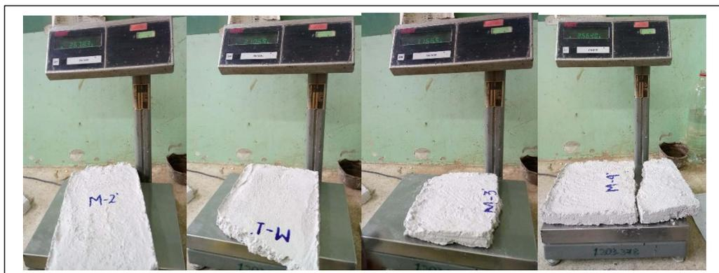
*Figura: 56 Peso de las dosificaciones sin cemento*
