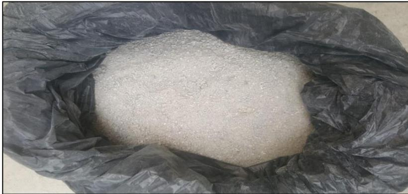
*Figura: 31 Escombros de Hormigón triturados Agregado fino*
