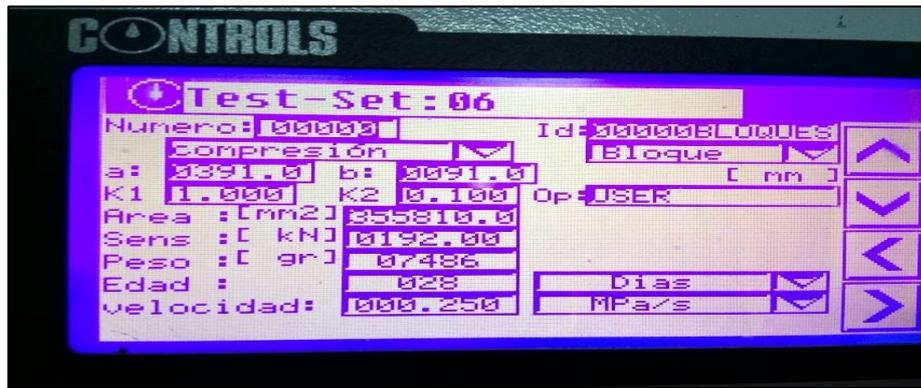
**Figura: 73** Datos ingresados en la maquina automática de compresión
