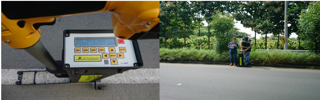
Ilustración 8. Resultado de La Retro reflectividad Inadecuada Tomado por: Alvarez Barrionuevo A. (2019)
