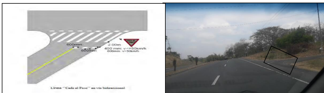
Ilustración 9. Ausencia De Señalización Ceda El Paso Tomado por: Alvarez Barrionuevo A. (2019)
