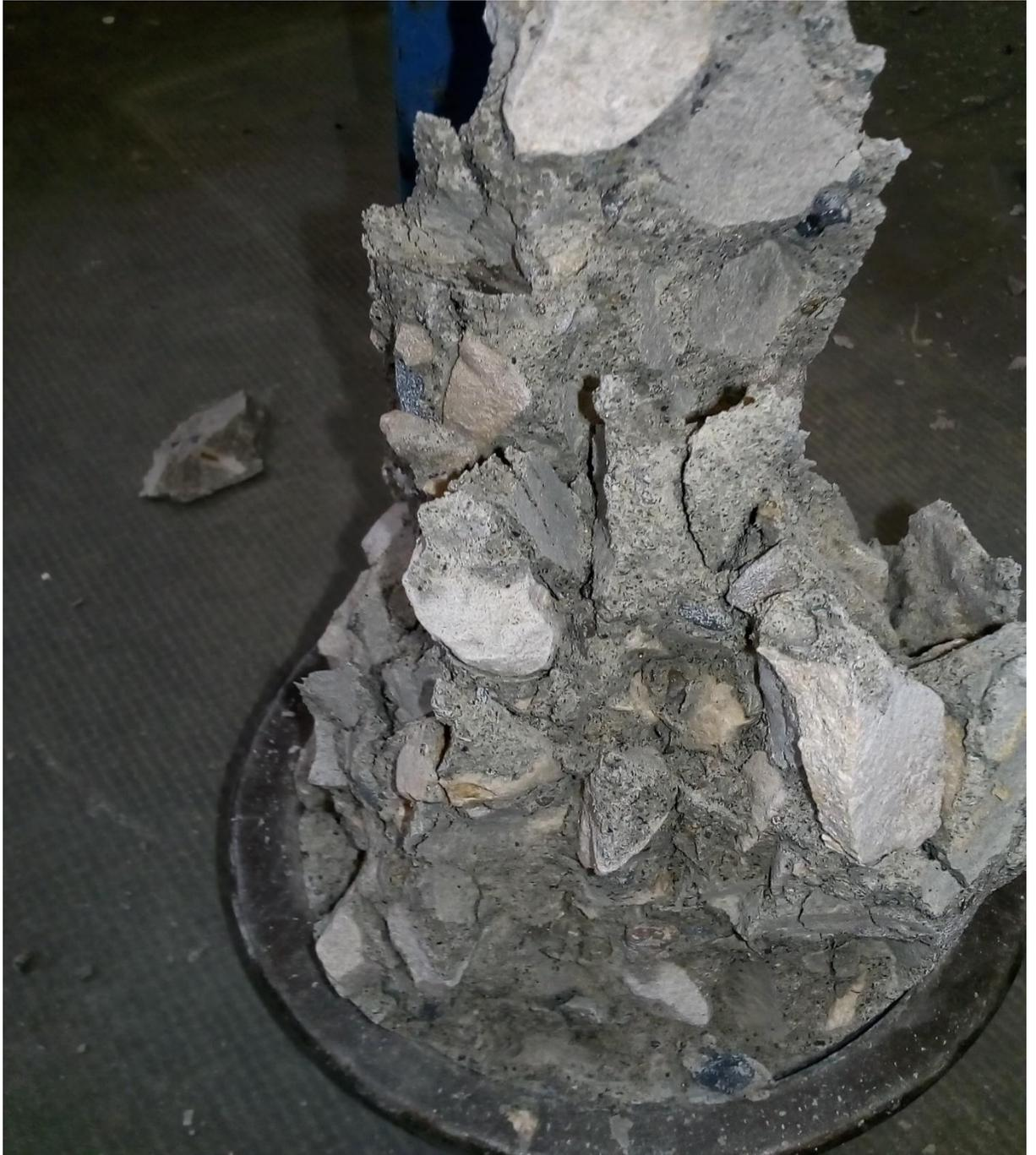
**Figura 19.** Agregado triturado alargado
