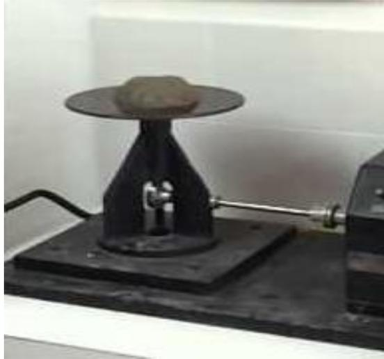
**Figura 6.**Prueba de fluidez del concreto.
