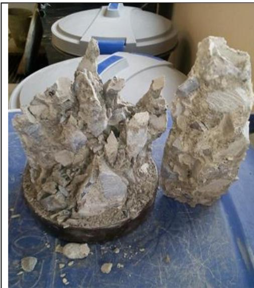
Con el tercer cilindro con el material caliza de la cantera de Huayco se evidencia que el agregado es irregular y angular teniendo un aspecto de ser puntiagudos en sus formas geométricas considerando el criterio de que ha adquirido una adherencia mayor en comparación a los 2 cilindros anteriores, la forma después de los ensayos de la Resistencia a la compresión nos permite concluir los espacios vacíos han sido mínimos para que exista una adherencia optima.
