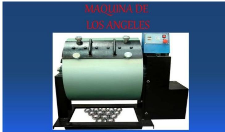
**Figura 5.** máquina para el ensayo de “los Ángeles”
