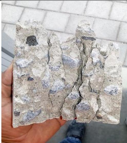
Con el cuarto cilindro que es un basalto azul de la cantera de Manabí se observa que la adherencia del agregado a la pasta de cemento Portland fue mayor ya que los espacios vacíos han sido cubiertos por la pasta debido a que la forma irregular y angular del material lo permitían, al observar la rotura del cilindro se evidencia una diferencia en comparación a los cilindros anteriores ya que ha sido consolidada en pocas piezas al roturarse el hormigón dando esa Resistencia de diseño.
