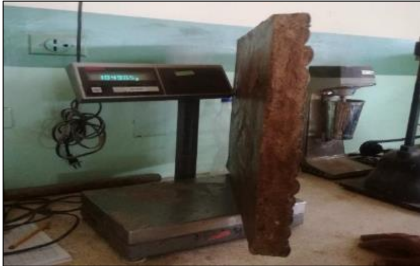
Imagen 74: Colocación del panel en la balanza.
