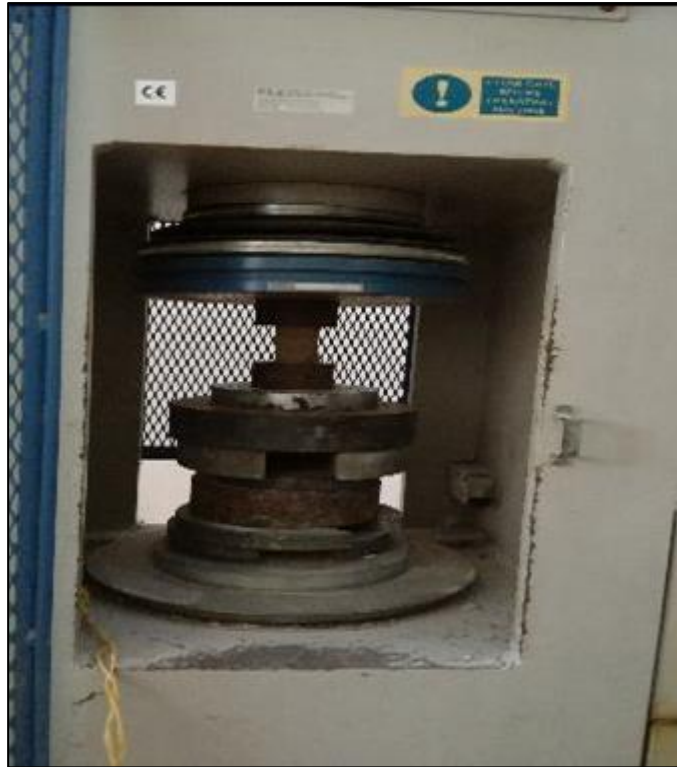
Imagen 104: Ensayo a compresión del mortero.
