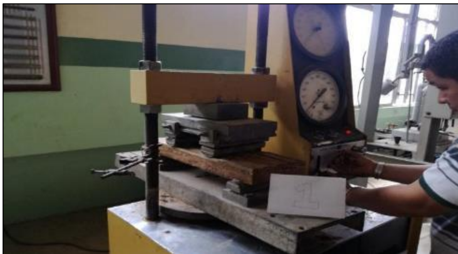
Imagen 77: Colocación del panel en la maquina universal.
