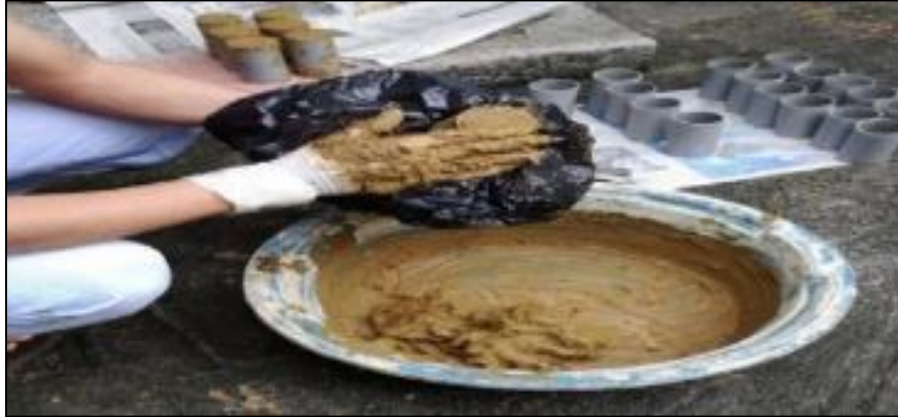
Imagen 63: Colocación de la muestra en los cilindros.
