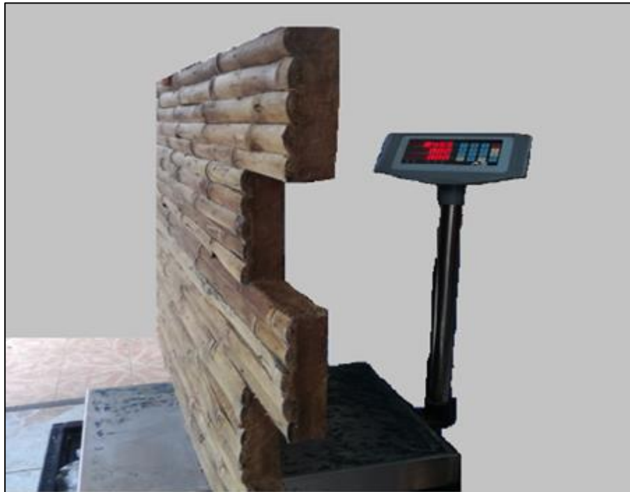
Imagen 107: Peso del Panel modular - 38,10Kg.
