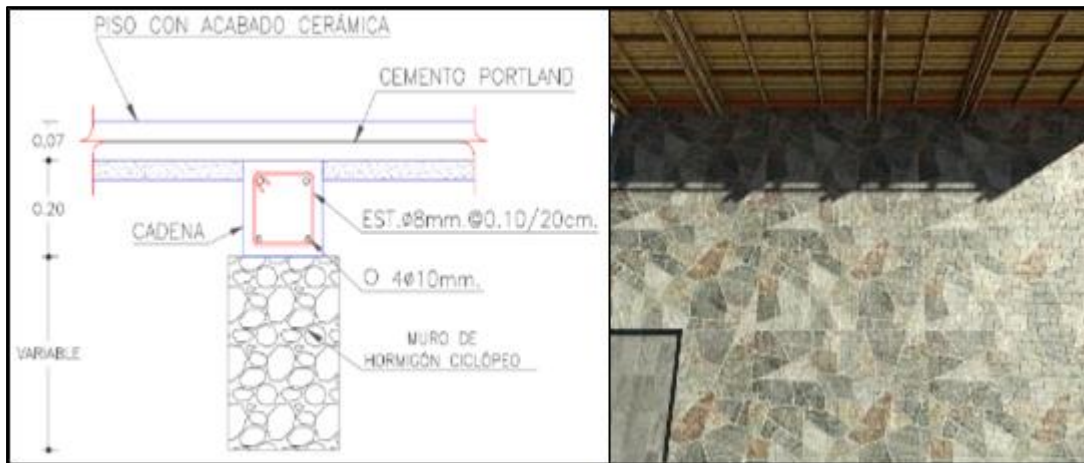
Imagen 92: Detalle de piso con acabado de desperdicio de cerámica.
