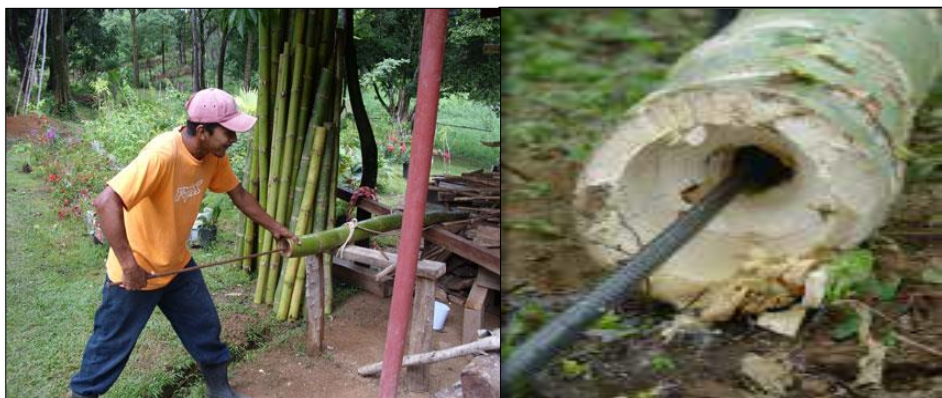
Imagen 19: Perforación de la caña guadúa.
