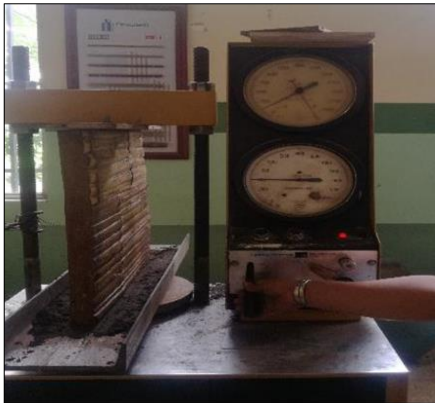
Imagen 105: Ensayo a compresión máxima del panel.
