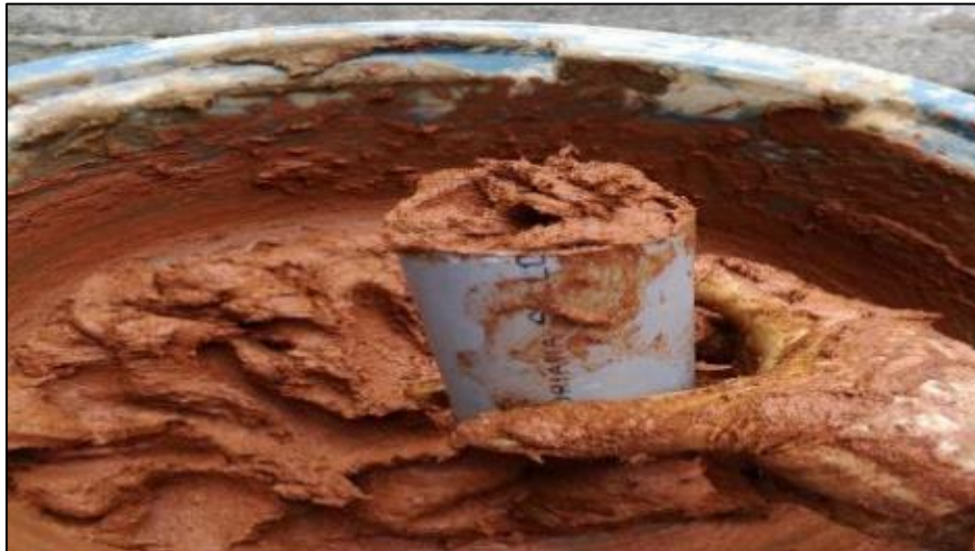
Imagen 64: Colocación de la muestra en los cilindros.
