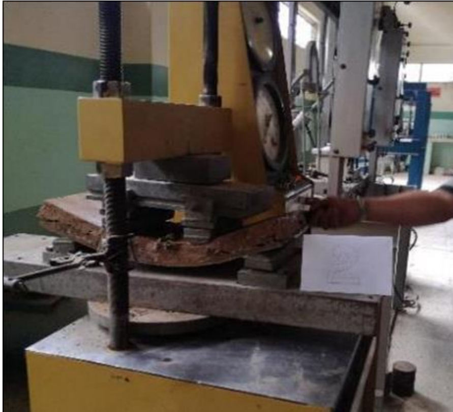
Imagen 106: Ensayo a flexión máxima del panel.
