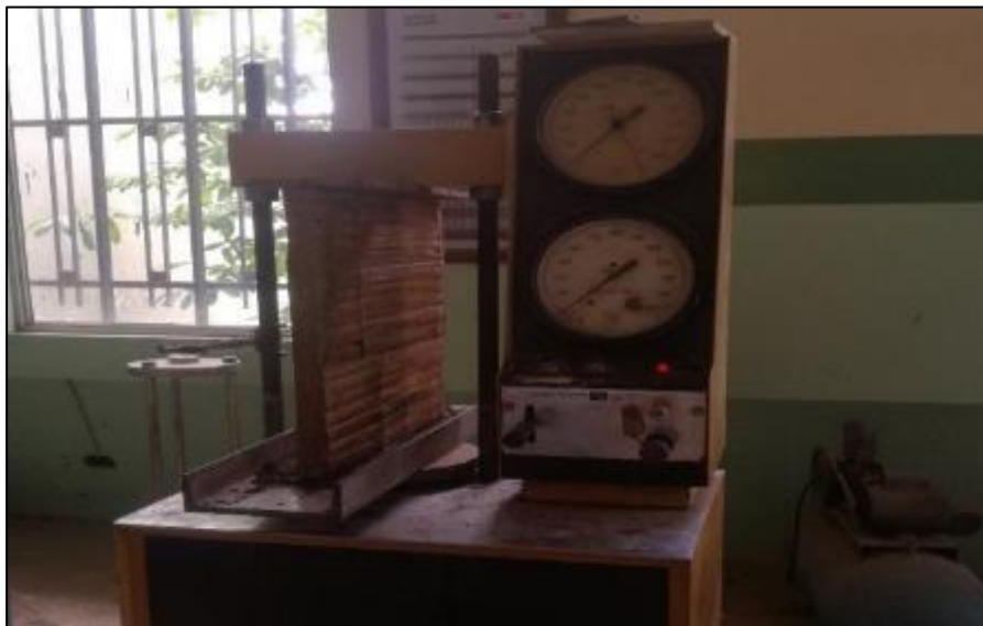
Imagen 75: Colocación del panel en la maquina universal.
