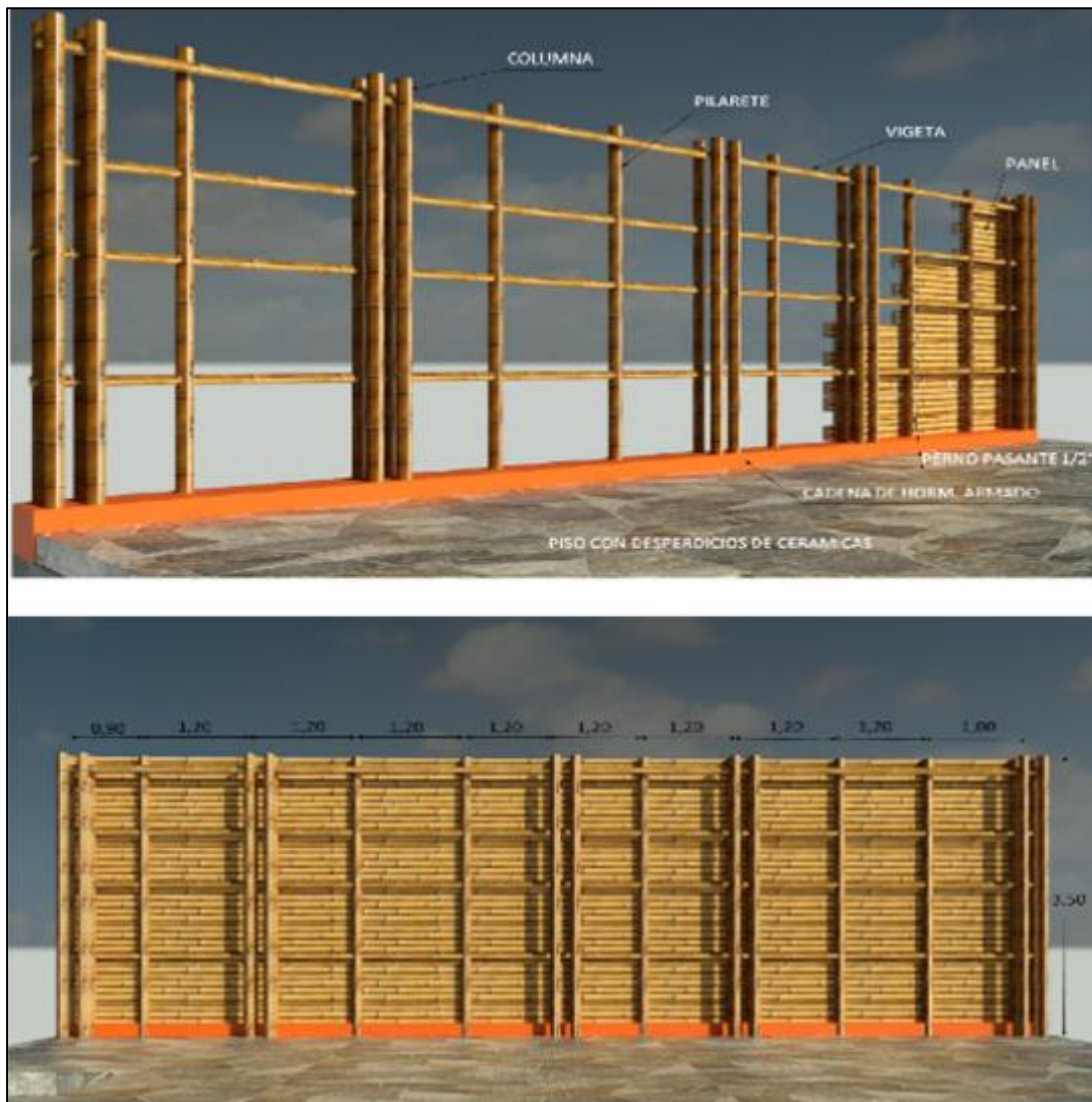
Imagen 91: Armado estructural de vivienda con paneles modulares
