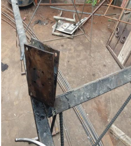
Figura 34. Perforación de las platinas Elaborado por: Pallo Sevillano, F. (2018)
