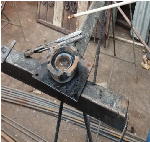
Figura 32. Platina soldada al ruliman giratorio
