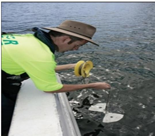
**Figura 10** Forma de medir turbidez del agua usando un disco Secchi
